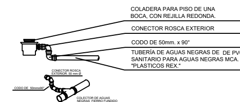
D-08 COLADERA PARA PISO USO SANITARIO ESC. 1/4"
