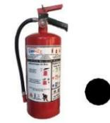
ESTOS EXTINTORES CONTIENEN UN SOLUCIÓN ACUOSA A BASE DE ACETATO DE POTASIO PARA SER UTILIZADOS EN LA EXTINCIÓN DE FUEGOS DE ACEITES VEGETALES O GRASAS ANIMALES CON REFRIGERANTE AISLANDO LA SUPERFICIE DE OXIGENO DEL AIRE EXTINGUIENDO EL FUEGO.
