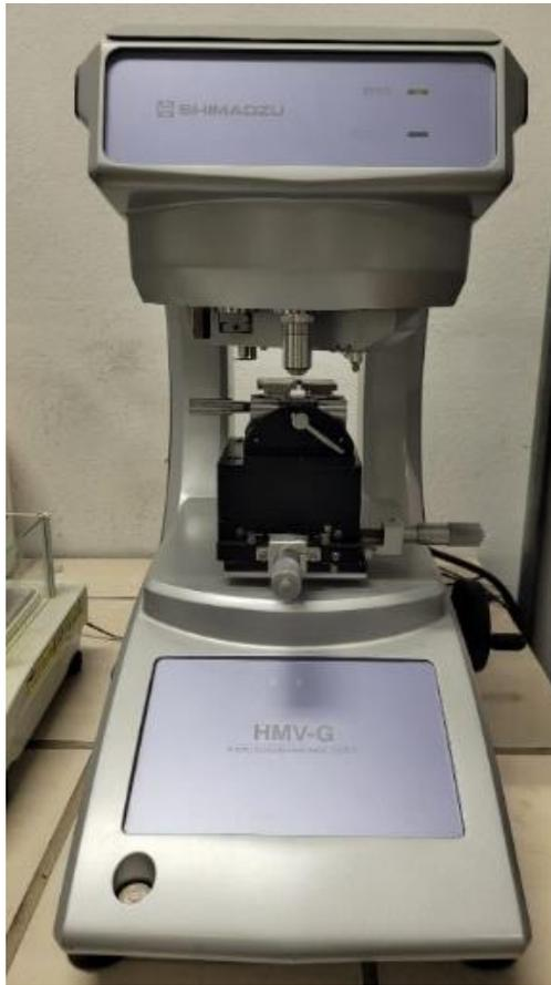
*Figura 22. Equipo de microdureza Vickers con la muestra montada.*
