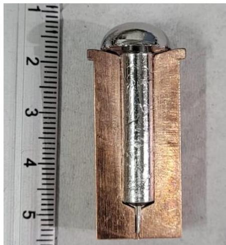
*Figura 15. Probeta obtenida dentro del molde de cobre.*
