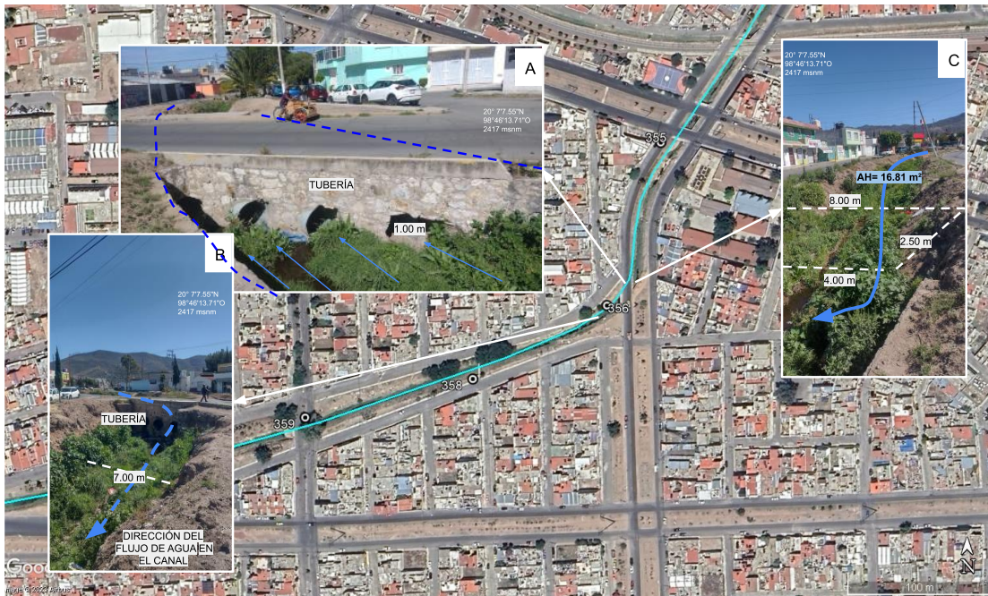
Figura 170. Imagen Satelital Google Earth con Red Hidrográfica Natural, Fotografía A: canal con cambio de dirección del flujo con tubería de 1.00 metro de diámetro, Fotografías B y C: muestran nuevamente la reducción del area hidráulica de este canal.
