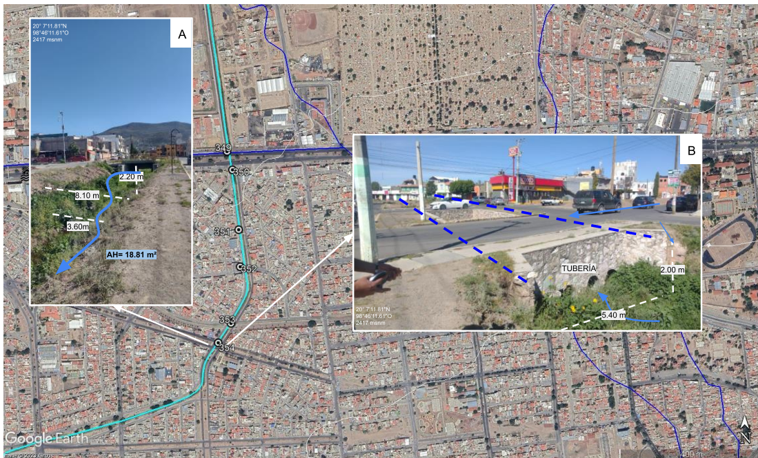
Figura 168. Imagen Satelital Google Earth con Red Hidrográfica Natural, Fotografías A, B, C y D: caracterización del afluente con dimensiones y dirección del flujo en el canal.
