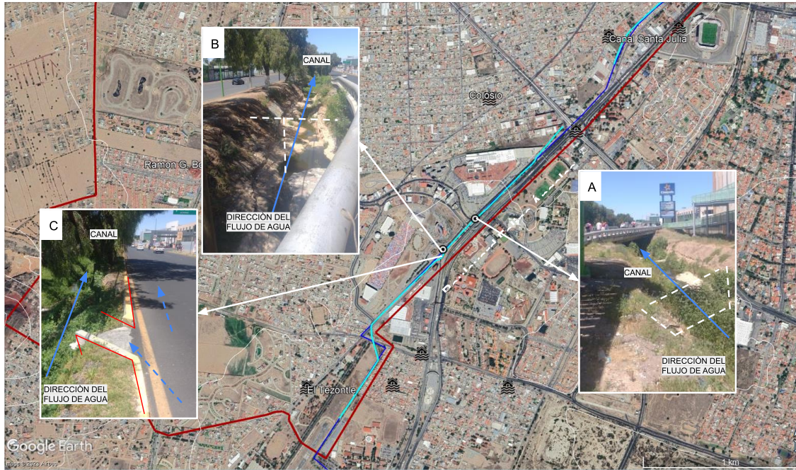
Figura 136. Imagen Satelital Google Earth con fotografías de campo en la que se muestra el límite oriental del parteaguas, de la MHU9. A) Fotografía que muestra la dirección de la obra hidráulica y su transformación dentro de la ZU. B) Fotografía que muestra el canal y tuberías que desembocan al mismo. C) Fotografía que muestra obras de para desahogar las vialidades y el agua fluya sobre el canal.
