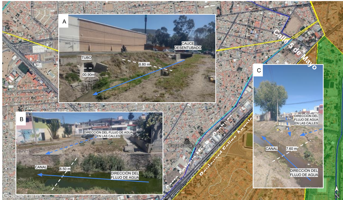
Figura 144. Imagen Satelital Google Earth. A), Fotografía A: Se observa el canal de Santa Julia en donde se des entuban distintos drenes de agua, y el flujo del agua es hacia el suroeste en la Colonia Sta Julia. Fotografía B y C, se muestra que el agua que escurre por las calles colindantes al canal llega desde la parte nororiente de la microcuenca hasta la Carretera. Antigua México-Pachuca.
