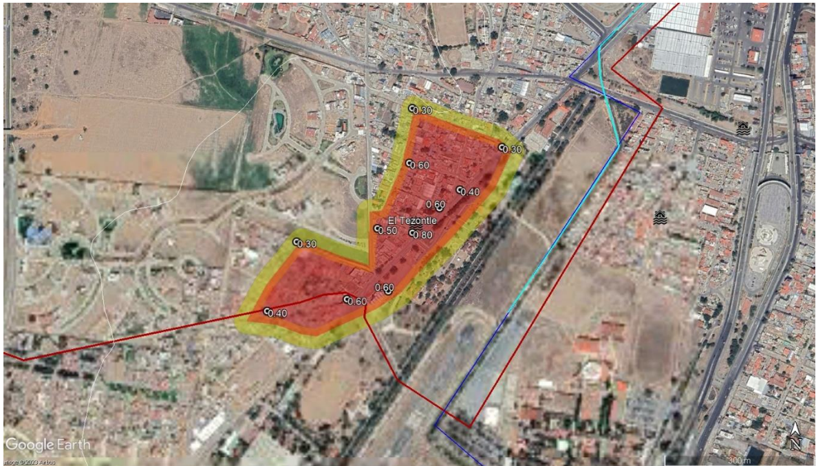
Figura 115. Imagen de satélite de la Colonia El Tezontle, se aplicó una clasificación de peligro utilizando colores para representar distintos niveles de peligro. Amarillo: Áreas con Baja Probabilidad de Peligro. Naranja: Áreas con Probabilidad Moderada de Peligro Rojo: Áreas con Alta Probabilidad de Peligro.
