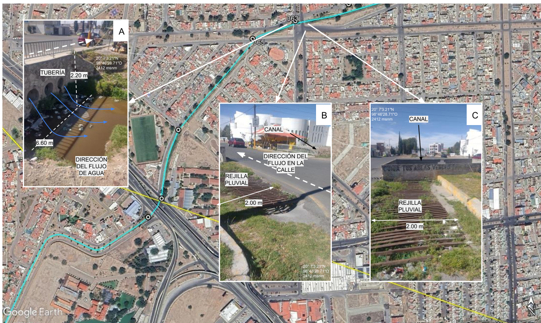
Figura 141. Imagen Satelital Google Earth. A) Fotografía que ilustra la tubería por debajo de un puente, donde el área hidráulica se redujo al diámetro de tres tubos de 1.2 m de diámetro. B) Fotografía con la dirección que sigue el agua por la Avenida Piracantos y una rejilla pluvial. C) Fotografía de una rejilla pluvial con basura y sedimentos entre la Avenida Piracantos y Avenida Insurgentes en Pachuca de
