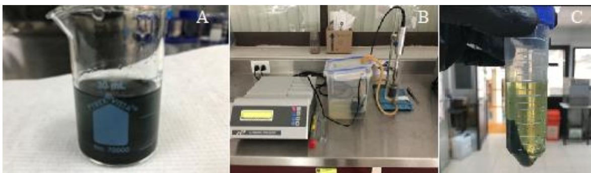
Figura 5. Formación del composito rGO_q@VO_x , A) dispersión de rGO_q y VO_2 en mezcla agua desionizada/etanol, B) sistema de ultrasonido, C) lavado del composito.
