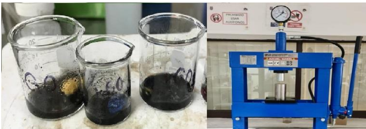
Figura 6. Preparación de pastas para electrodo y prensado de electrodos en prensa .
