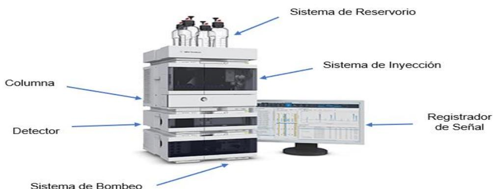
**Figura 3. Partes de un equipo de cromatografía de líquidos de alta resolución.**
