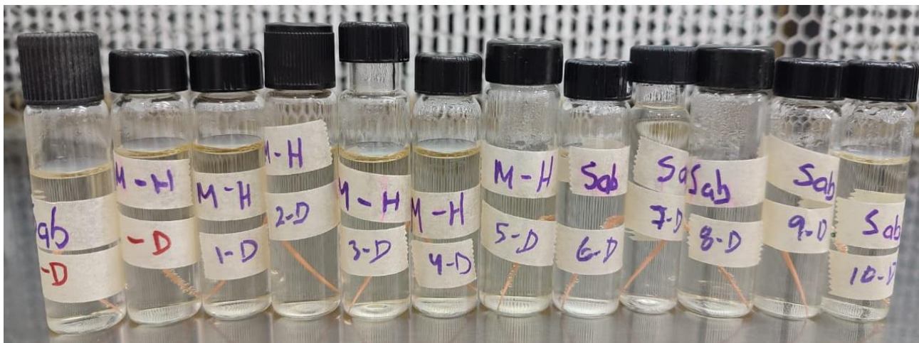
Fotografía XI. Tubos con conos de gutapercha de cajas selladas de la marca Dentsply con sus respectivos controles de cada caldo, después de 48h.
