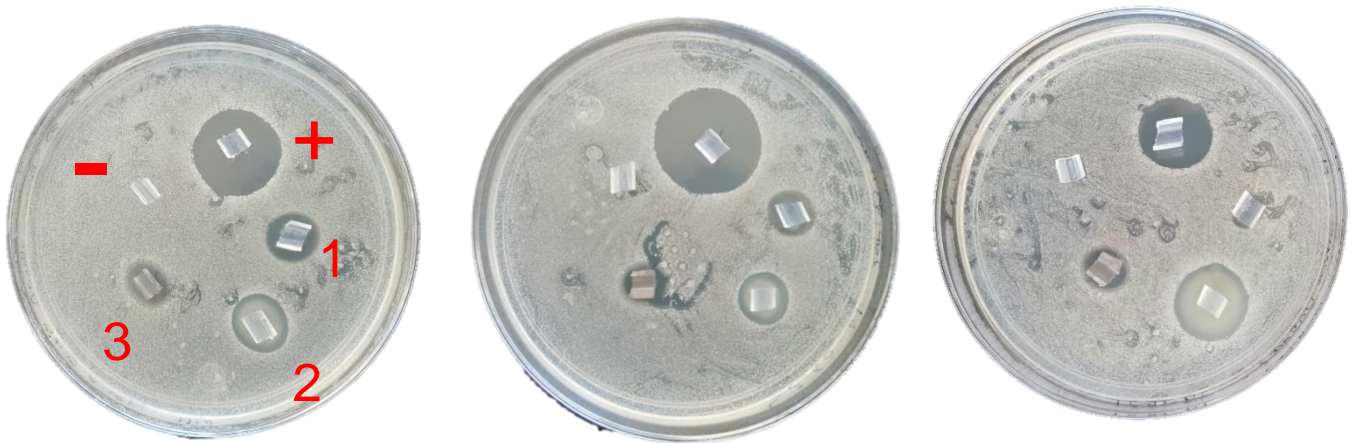
Ilustración 14 Nanpartículas de plata funcionalizadas durante 48 horas en tubos de Penrose de silicona en placas de S. mutans
