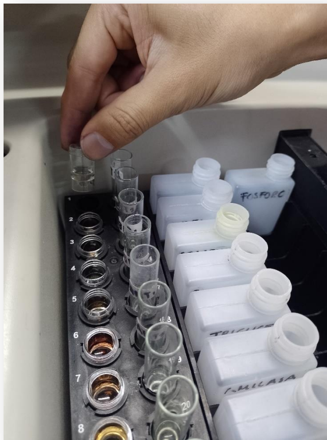
Imagen 64. La copilla previamente rotulada se coloca en el rack de reactivos y muestras para que el equipo haga su lectura de los diferentes analitos.
