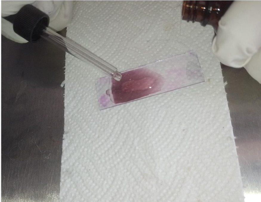
Imagen 85. En cuanto el extendido esté seco, debe colocarse resina, posteriormente, se debe agregar un cubreobjetos para que pueda distribuirse por capilaridad.
