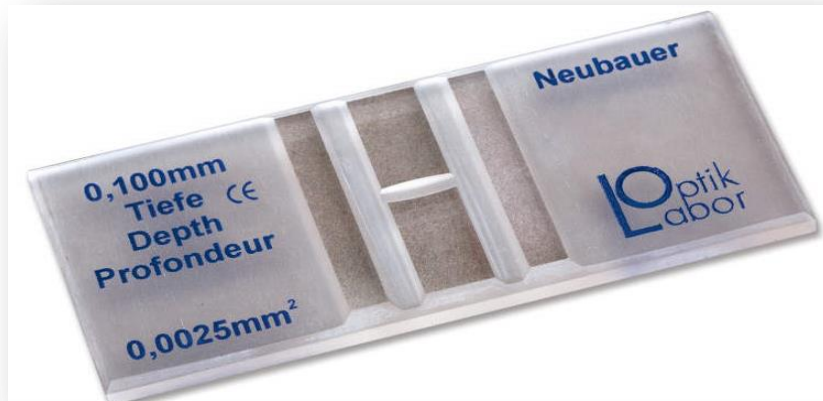
Imagen 13. Cámara de Neubauer empleada para realizar el conteo de forma manual. Recuperada de internet.
