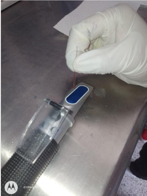
Imagen 8. Se deposita una gota de plasma en el refractómetro, y se direcciona a una fuente de luz para tener mejor visibilidad.
