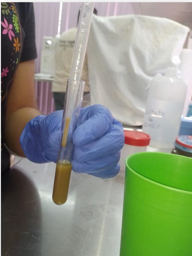
Imagen 38. Se deposita en un tubo de ensayo con ayuda de una pipeta de plástico, aproximadamente 10 ml de la mezcla.
