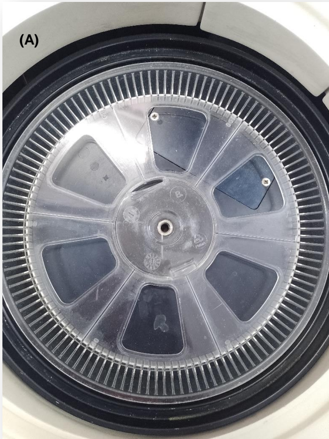
Imagen 60. (A) El rotor que se ingresa debe ser transparente para que no haya interferencia en el paso de luz, cuenta con 120 pocillos. (B) Una vez insertado debe darse clic en “ Nuevo Rotor ”.
