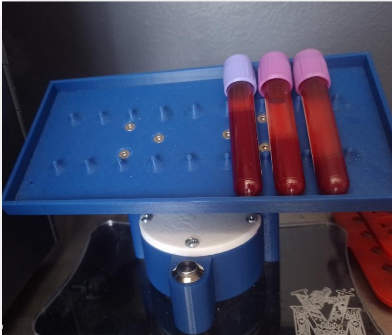
Imagen 10. Los tubos son colocados en el mezclador para evitar la formación de microcoágulos. Fotografías tomadas en las instalaciones de "Laboratorio Veterinario México", por Vanegas L., 2022.
