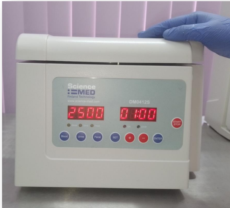
Imagen 39. Fotografía de la centrifuga, la cual ya se encuentra programada a las correctas revoluciones para este proceso.
