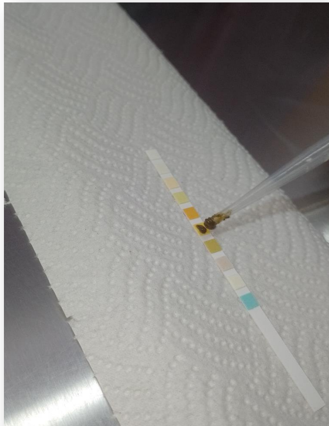
Imagen 44. Se deposita una gota de la mezcla en la colchoneta de tira reactiva para determinar sangre.
