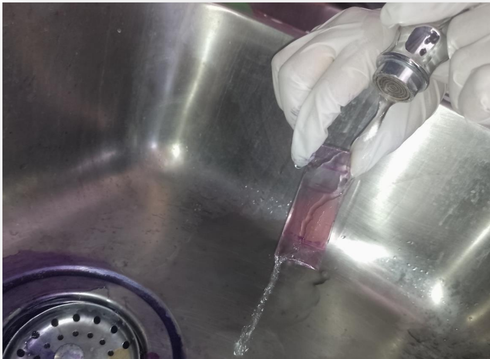
Imagen 84. Una vez pasado el tiempo, debe de enjuagarse al chorro de agua común. Fotografía tomada dentro de las instalaciones de "Laboratorio Veterinario México", por Vanegas L., 2022.
