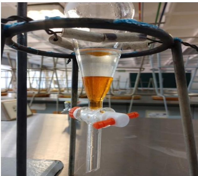
Figura 8. Metodología FEUM 13va Ed. modificada, reducción del volumen de la fase acuosa.
