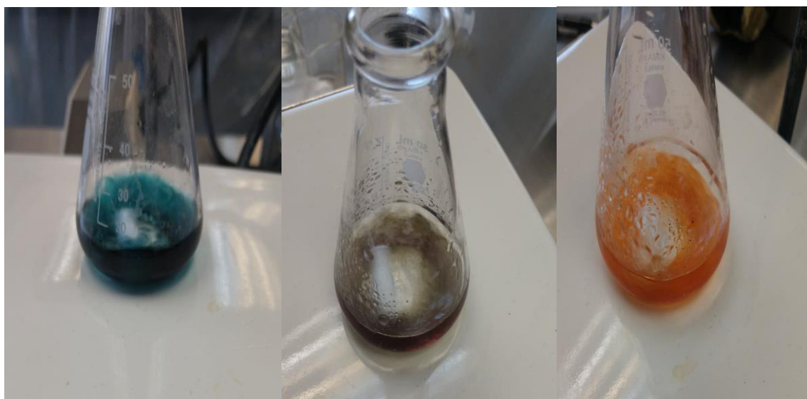
Figura 11. Determinación de mercurio (valorante-bureta) con ditizona (analito), (a) inicio, (b) antes del PE, (c) PE y después del PE.
