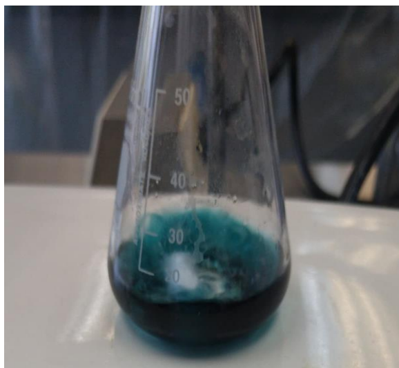
Figura 9. Valoración en continuo en un matraz Erlenmeyer y agitación mecánica.
