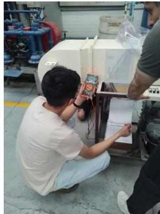
***Figura 3.2.2.9. Toma de lectura del voltaje de alimentación al ventilador.***
