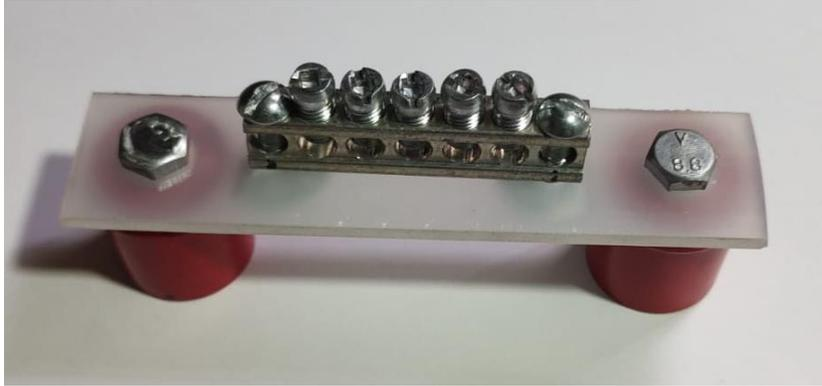
***Figura 4.1.7. Montaje de barra de cobre y aislador.***
