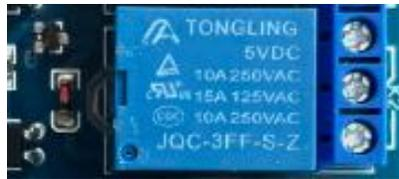
*Figura 3.2.3.2. Modulo relevador JQC-3FF-S-Z.*
