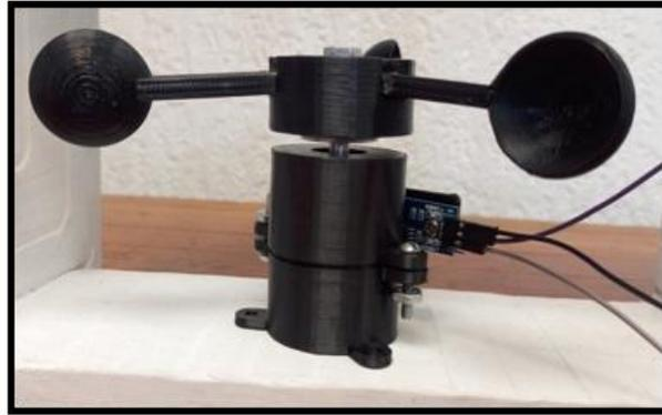
**Figura 3.2.2.14.** *Ensamble del anemómetro desarrollado.*
