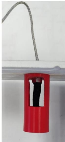
***Figura 3.2.2.4. Montaje de los termopares para medir la temperatura de bulbo húmedo.***
