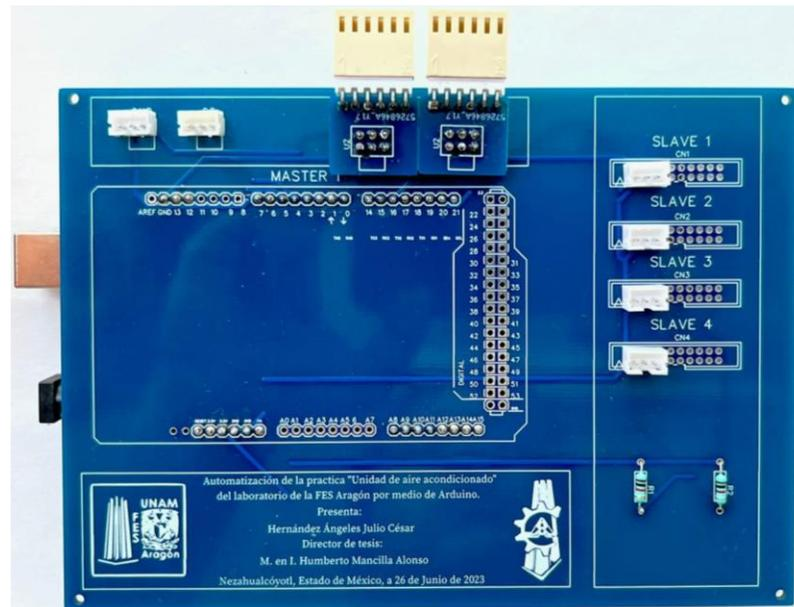
*Figura 4.1.2. PCB para el microcontrolador maestro.*
