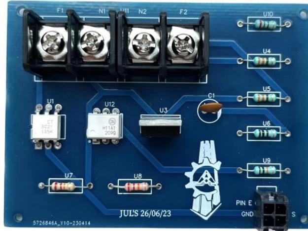
**Figura 3.2.3.5.** Placa desarrollada para control de fase a 120V-60Hz.
