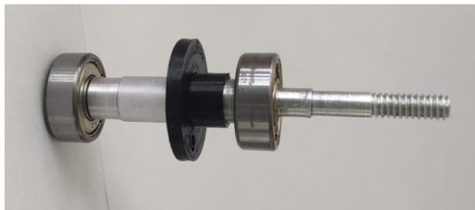
**Figura 3.2.2.12.** Eje manufacturado para anemómetro.
