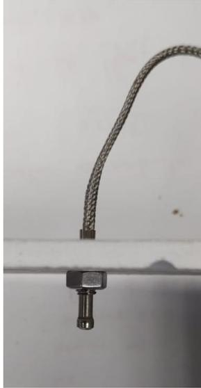
***Figura 3.2.2.3. Montaje de los termopares para medir la temperatura de bulbo seco.***
