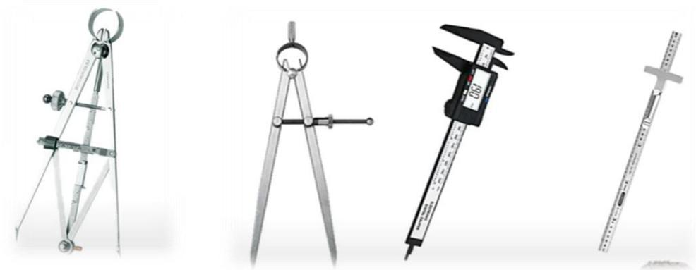
Figura 31. A) Compas tridimensional, B) Compas de puntas secas, C) Vernier, D) Regla milimétrica.
