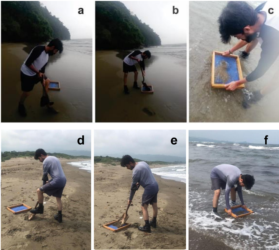
Figura 9. a, toma de muestra de arena en playa El Jicacal, Veracruz; b, Descarga de la arena en el tamiz; c, tamizado de arena; d, Toma de muestra de arena en playa Montepío, Veracruz; e, descarga de la arena en el tamiz; f, tamizado de arena.
