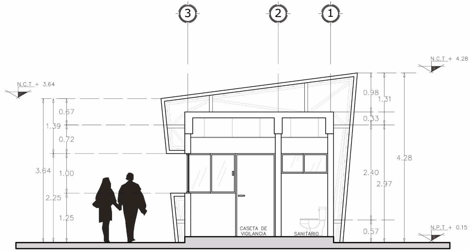
CORTE LONGITUDINAL A-A' Casetta de Vigilancia
