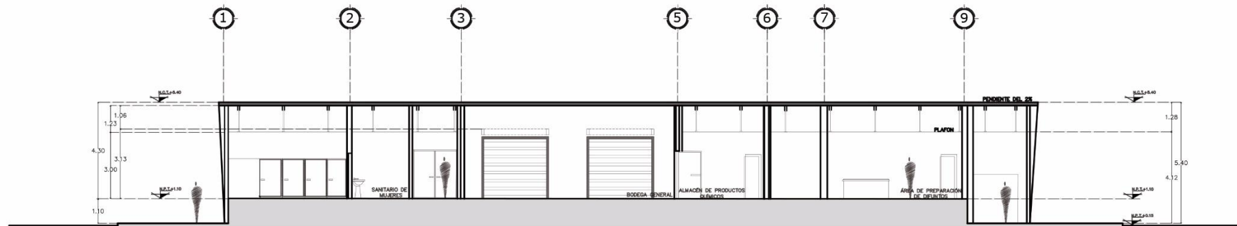
CORTE ARQUITECTÓNICO B-B' BODEGA ALMACEN
