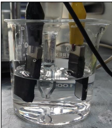
Figura 20: Electrodo sumergidos en sulfato de sodio para realizar cronoamperometría
