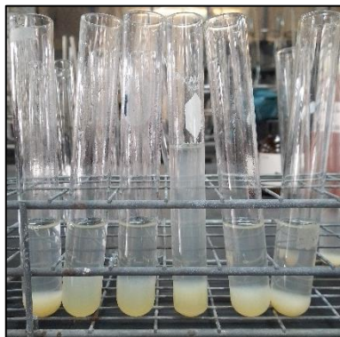
Figura 13: Prueba de tubos realizada en agua residual, utilizando como agente coagulante sulfato férrico (77.5 – 87.60 ppm)
