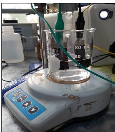
Figura 21: Celda electroquímica montada para la cronoamperometría con agitación
