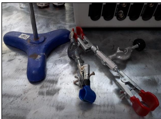
Figura 16: Soporte universal y pinzas con nuez para sostener electrodos
