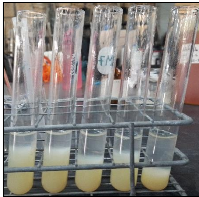
Figura 14: Prueba de tubos realizada en agua residual, utilizando como agente coagulante sulfato férrico (19.61 – 90.91 ppm)
