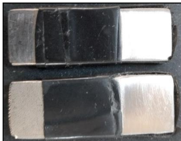
Figura 19: WE Y CE de acero dulce utilizados en cronoamperometría
