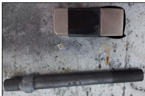
Figura 15: Electroodos, barra de acero dulce y grafito
