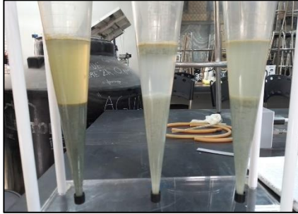
Figura 10: Sedimentación en cono Imhoff
