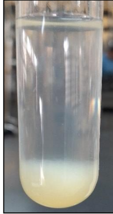
Figura 28: Concentración determinada de 84.25 ppm necesaria de sulfato férrico para coagular el agua residual
