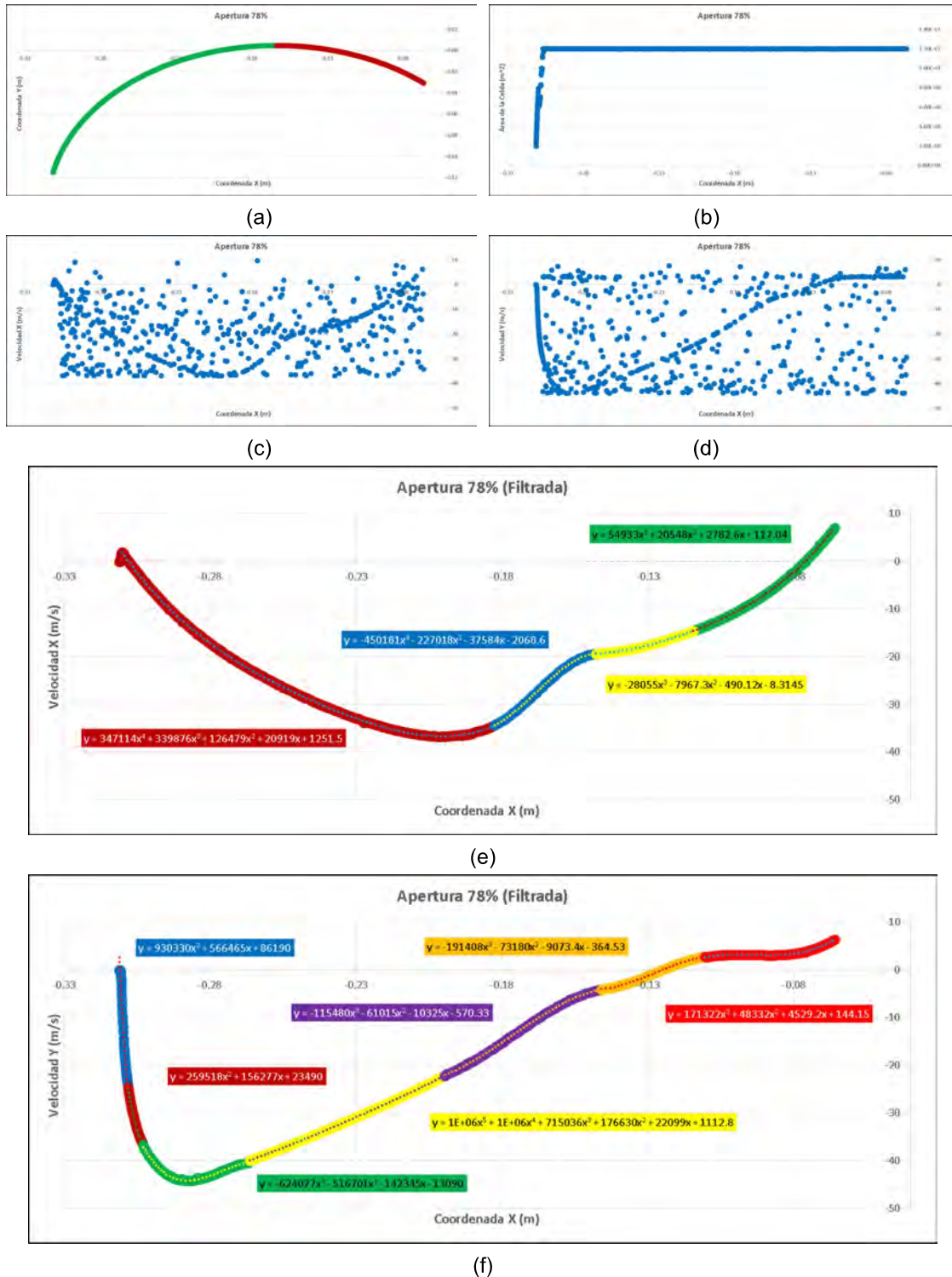
Figura 4.71: Componentes de la Velocidad del Fluido a la Salida de Inyector a 78% de Apertura. Perfil GA: (a) Puntos de Coordenadas de la Superficie de Salida del Inyector. (b) Área de las Celdas sobre el Eje X. (c) Promedios del Componente X de la Velocidad por Celda. (d) Promedios del Componente Y de la Velocidad por Celda. (e) Promedios Filtrados del Componente X de la Velocidad por Celda. (f) Promedios Filtrados del Componente Y de la Velocidad por Celda.
