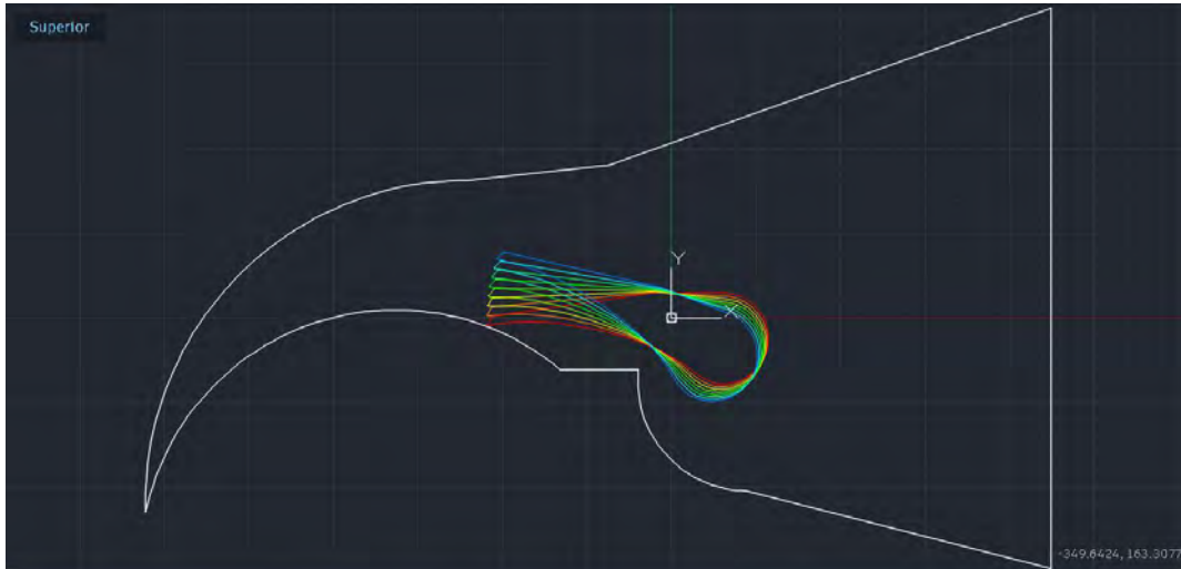
Figura 3.9: Posiciones de la Válvula de Paso en la Región del Inyector con Base a los Porcentajes de Apertura.
