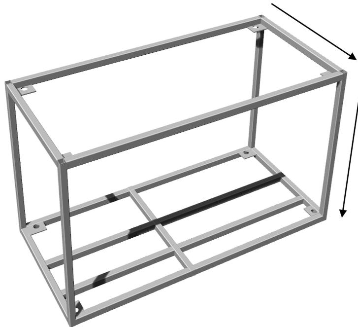
Figura 38. Mesa estructural de perfil tubular cuadrado de  $1\frac{1}{4}$  por  $1\frac{1}{4}$  de pulgada.
