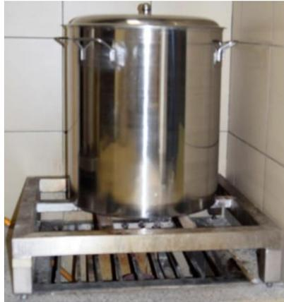
**Figura 19.** Olla de 100 L donde se lleva a cabo el proceso de limpieza por cocción.
