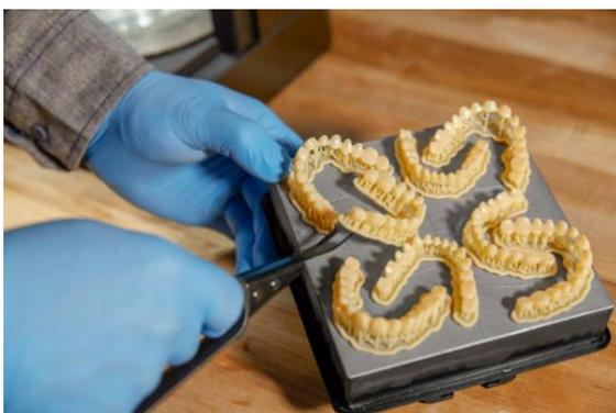
**Imagen 45.** Colocación de dientes sobre la base para el lavado principal <sup>(23)</sup>
