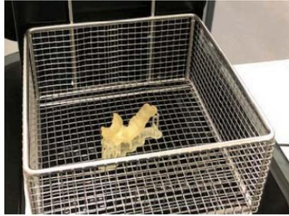
**FIGURA 66.** Lavado y secado de la impresión. *Recurso obtenido de: (69)*
