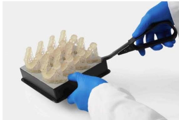
**FIGURA 65.** Retiro de impresión de la plataforma. *Recurso obtenido de:* (69)
