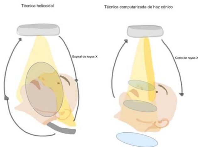
**FIGURA 4.** Proyección del haz de rayos x. (A) Técnica helicoidal. (B) Técnica de haz cónico. *Recurso obtenido de: Fuente propia.*
