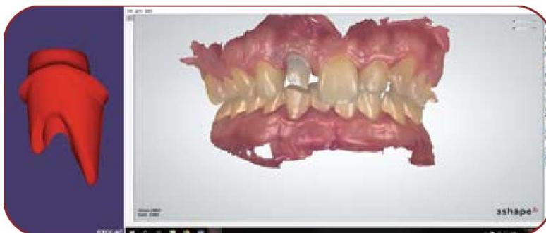
**FIGURA 84.** Diseño individual de un pilar. *Recurso obtenido de: (81)*
