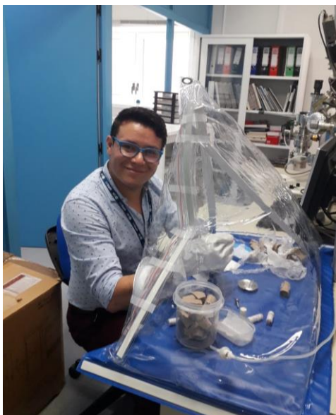
figura 20 Caja seca para tratar los catalizadores a caracterizar
