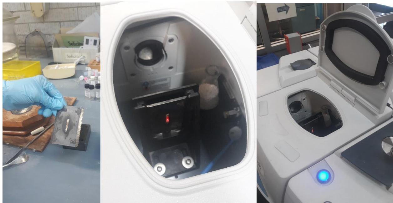
Ilustración 12. Uso de la técnica FTIR-ATR con pastilla de KBr para identificar residuos orgánicos en muestras de Tzicohuac (imágenes propias del autor).
