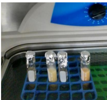
Ilustración 13. Extracción Asistida por Ultrasonido.
