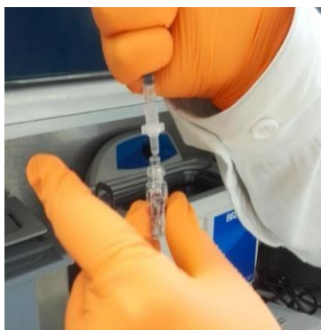
Ilustración 16. Filtración de extracto por sistema de disco y jeringa.
