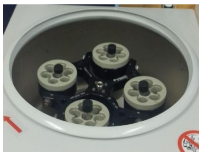
Ilustración 14. Separación del sedimento sólido usando centrifuga.
