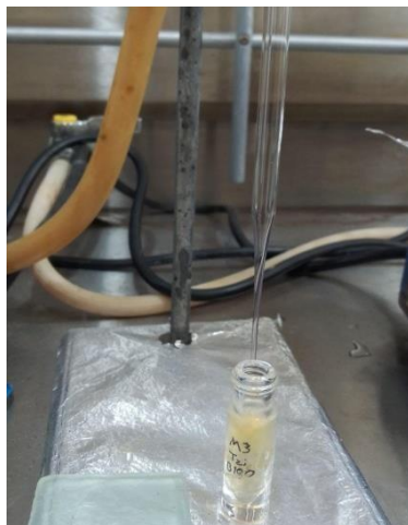
Ilustración 15. Sequedad con flujo de N 2 .
