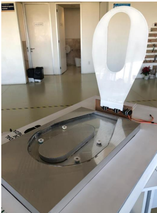
Figura 36. Cámara de limpieza y asiento.
