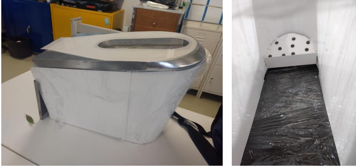
Figura 35. Contenedor, soporte y asiento pintados / vista interior del contenedor.
