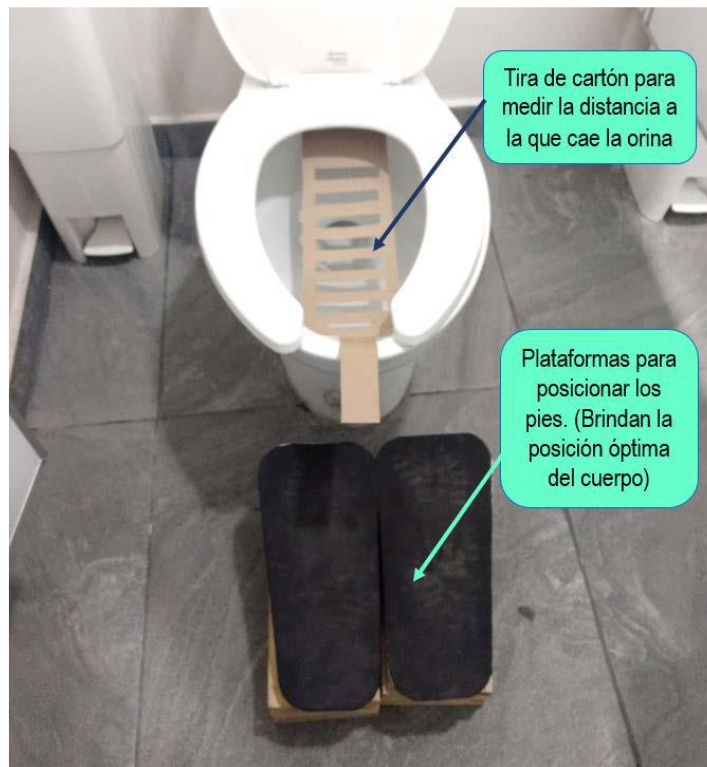
Figura 27. Prueba de separación de orina.
