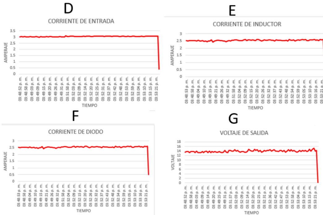
Fig. 178. Comportamiento de sensores de corriente a 25% primer caso de uso convertidor elevador (BOOST). Fuente: propia.
