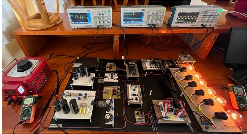
Fig. 135. Segundo caso de convertidor elevador (BOOST) a un 50%. Fuente: propia.
