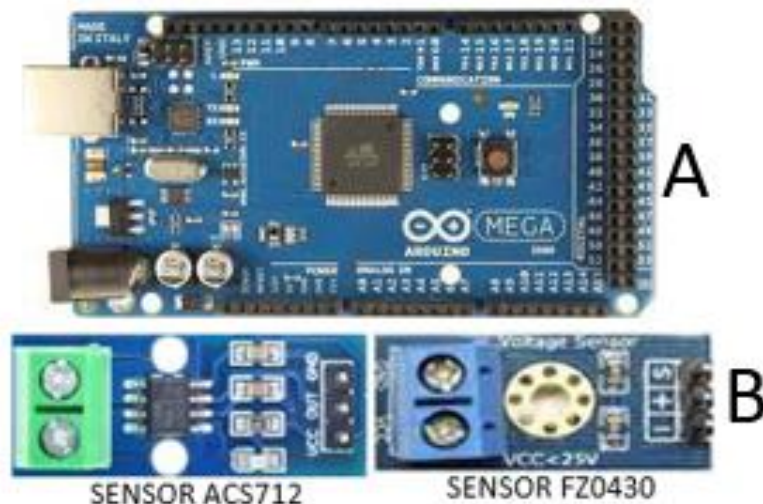
Fig. 93. Tarjeta de programación ARDUINO MEGA y sensores de voltaje y corriente. Fuente: Propia
