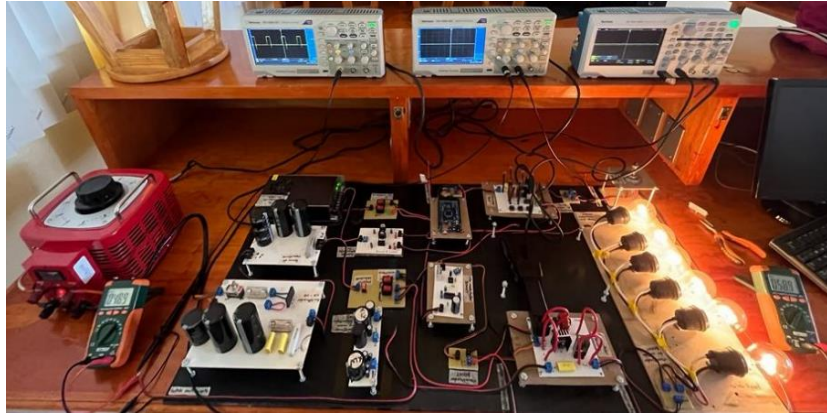
Fig. 141. Tercer caso de convertidor elevador (BOOST) a un 25%. Fuente: propia.
