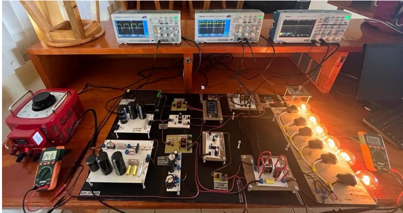
Fig. 138. Segundo caso de convertidor elevador (BOOST) a un 66%. Fuente: propia.
