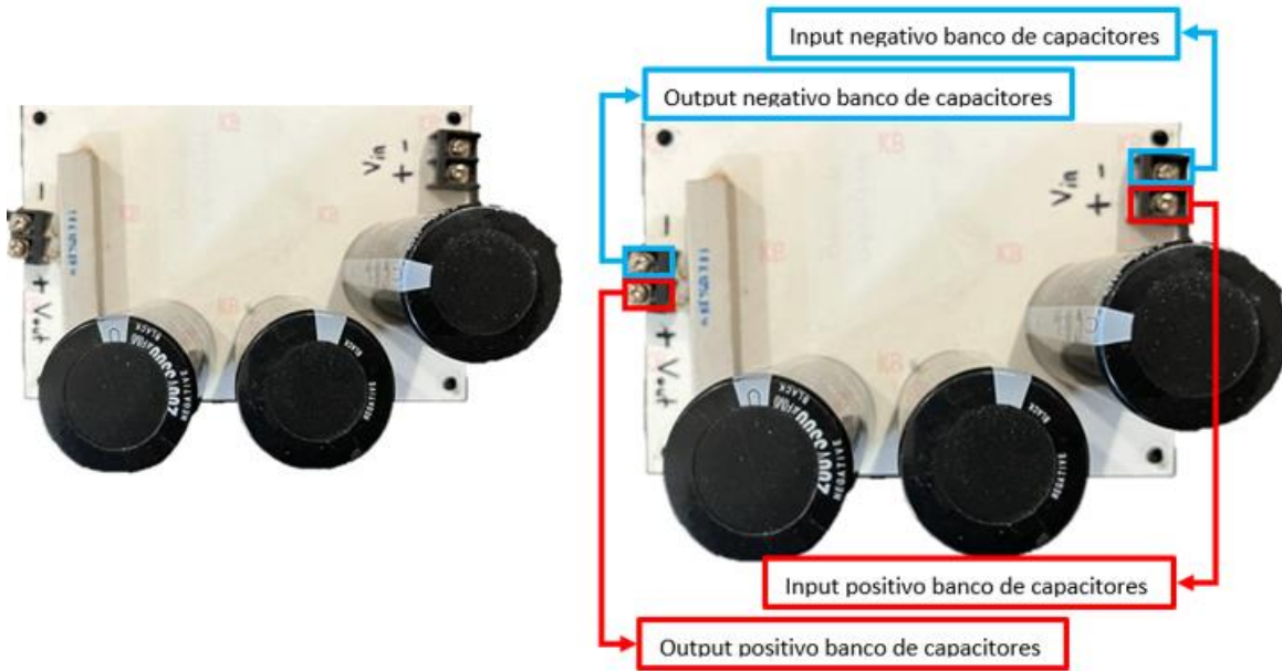
Fig. 101. Banco de condensadores. Fuente: propia.
