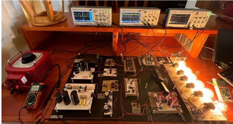
Fig. 144. Tercer caso de convertidor elevador (BOOST) a un 50%. Fuente: propia.
