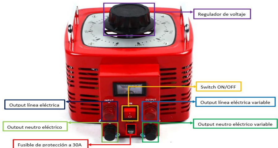
Fig. 98. Transformador variables VARIAC. Fuente: propia.
