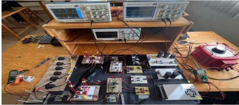
Fig. 151. Caso de convertidor reductor (BUCK) a un 25%. Fuente: propia.
