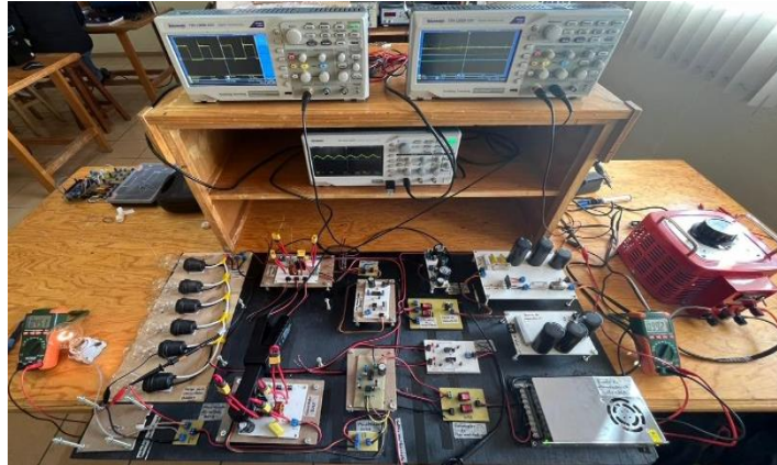
Fig. 154. Caso de convertidor reductor (BUCK) a un 50%. Fuente: propia.
