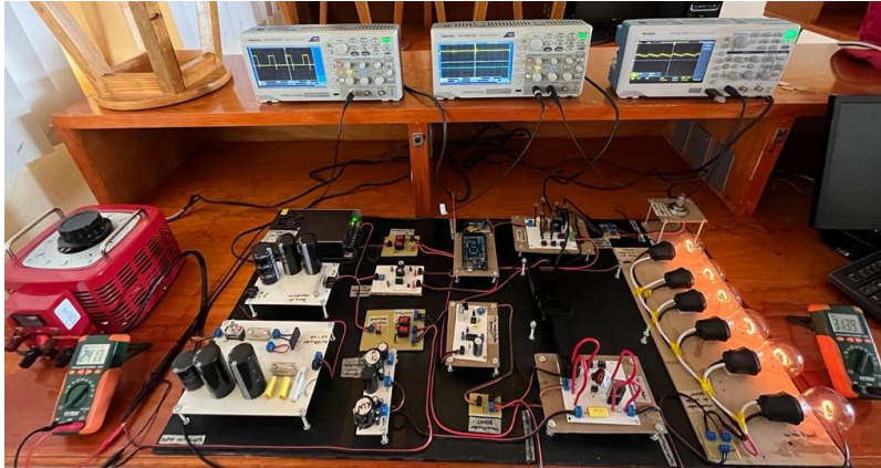
Fig. 132. Segundo caso de convertidor elevador (BOOST) a un 25%. Fuente: propia.
