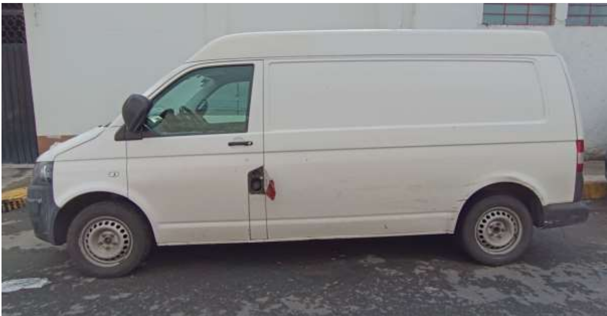
Figura 32. Furgoneta con ventanas reemplazadas por chapa en la zona de carga. Fuente: elaboración propia.
