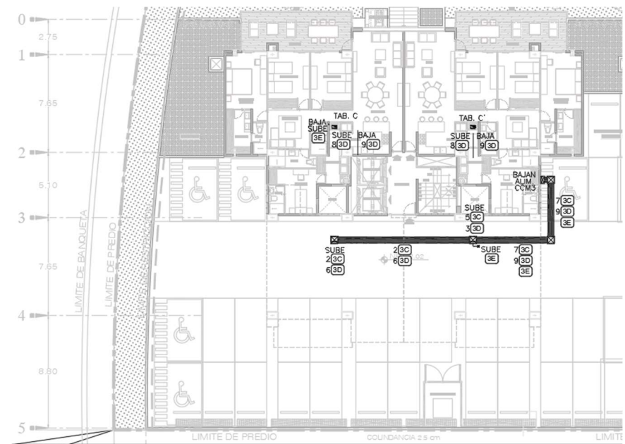
Imagen 44. Planta baja de Conjunto Torre 1 (Alimentadores generales) Propiedad Sinergia Arquitectura Integral S.A. de C.V.
