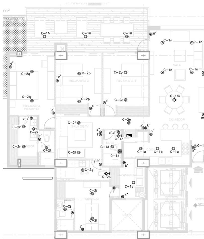
Imagen 37. Propuesta sembrado iluminación y contactos departamento Tipo Propiedad Sinergia Arquitectura Integral S.A. de C.V.
