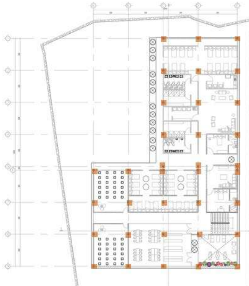
Img. 42 Estructura metálica compuesta de columnas tipo "C-1". Elaboración propia.
