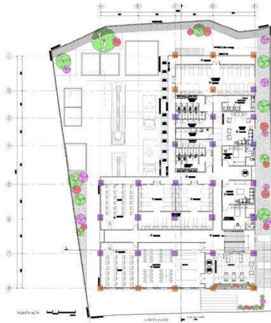
Img. 43 Estructura metálica compuesta de columnas tipo "C-1" y "C-2". Elaboración propia.
