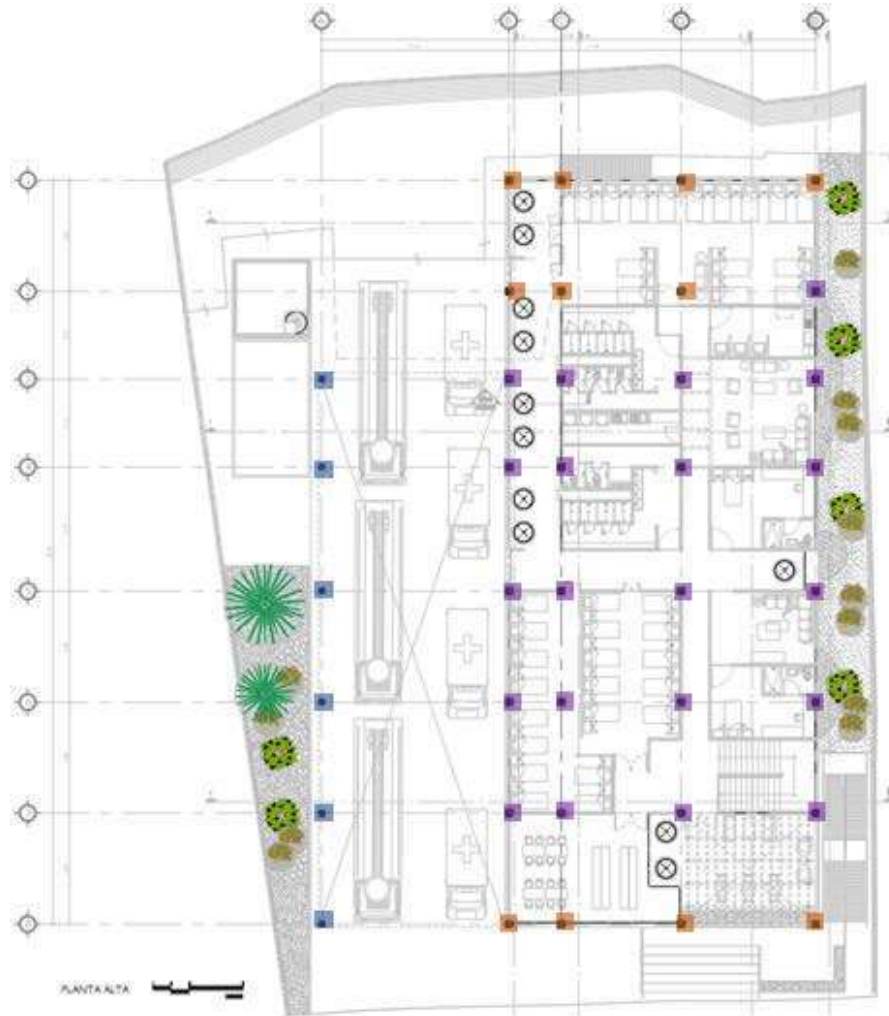
Img. 44 Estructura metálica compuesta de columnas tipo "C-1", "C-2" y "C-3". Elaboración propia.
