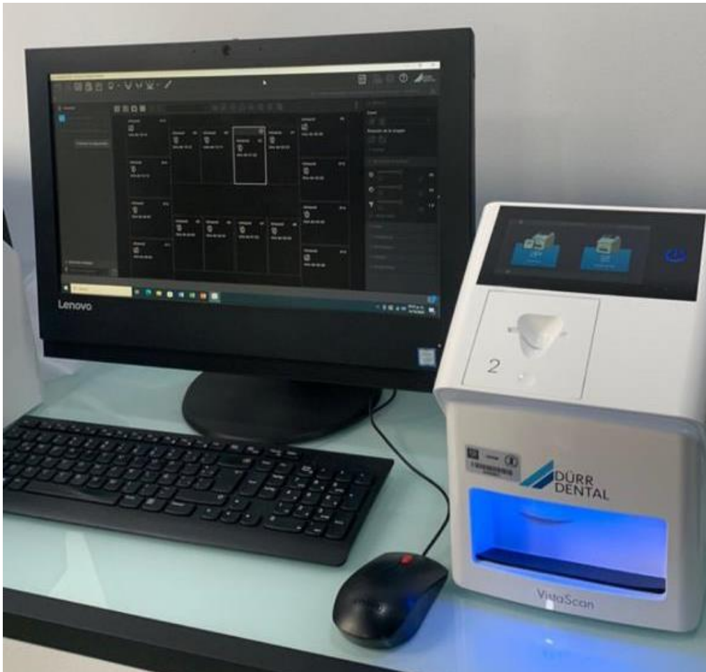
Fig. 22 Ordenador con software y escáner de placas de fosforo para la obtención de radiografías digitales en la facultad de odontología UNAM. (Fuente propia)
