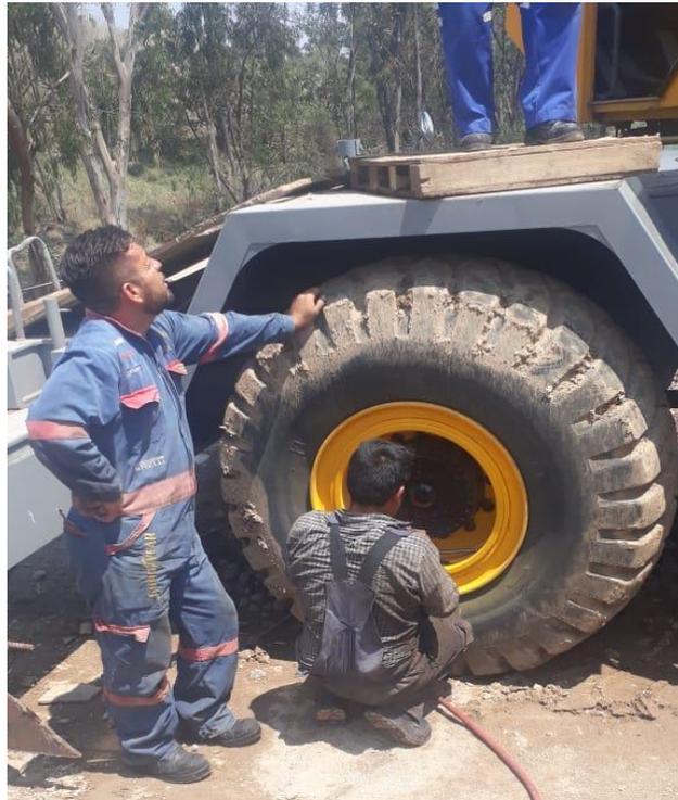
**Figura 6.6.1.3a.** Revisión de la llanta de la grúa Groove. Fuente: elaboración propia.
