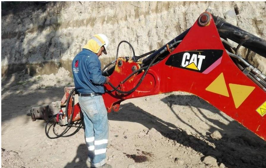
**Figura 5.4.2.h.** Adaptación del martillo hidráulico a la retroexcavadora CAT 416 por el mecánico de la obra. Fuente: elaboración propia.
