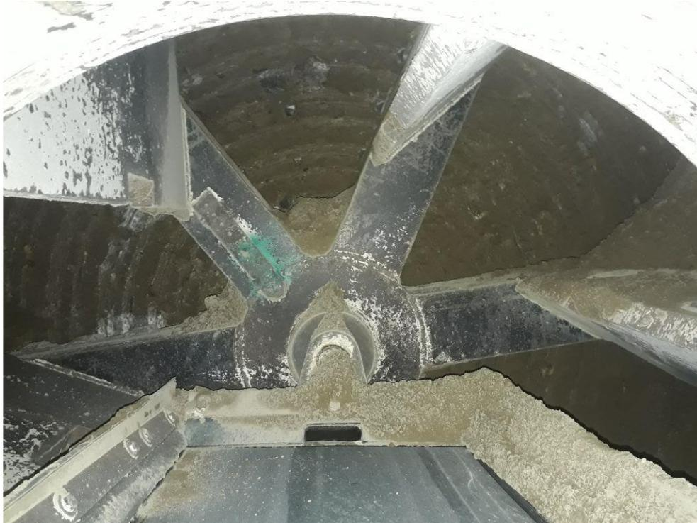
**Figura 6.5.2.b.** Frente de excavación observado desde el escudo excavador. Fuente: elaboración propia.
