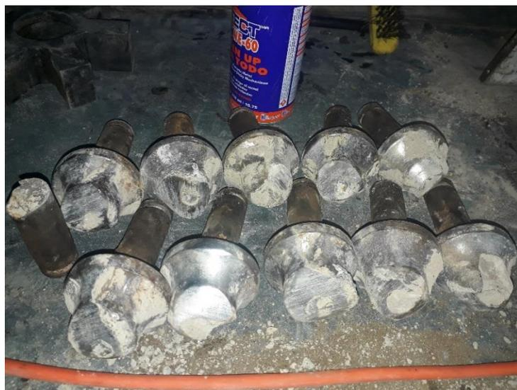
**Figura 6.6.2.g.** Cambio de picas deterioradas. Fuente: elaboración propia.
