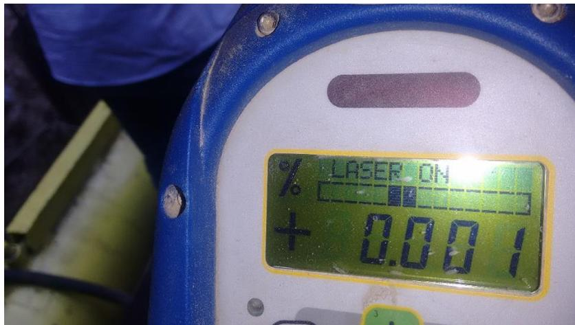
**Figura 6.4.2.b.** Calibración de láser en base a la pendiente establecida para el túnel. Fuente: elaboración propia.
