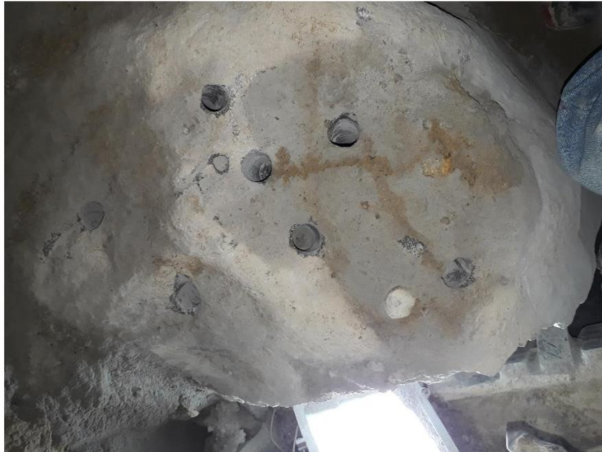
**Figura 6.6.2.c.** Barrenos en roca por medio de Roto martillo Hilti. Fuente: elaboración propia.
