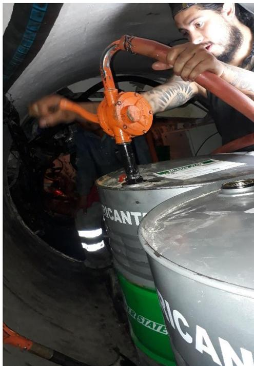
**Figura 6.6.1.2a.** Cambio de aceite hidráulico del escudo excavador. Fuente: elaboración propia.
