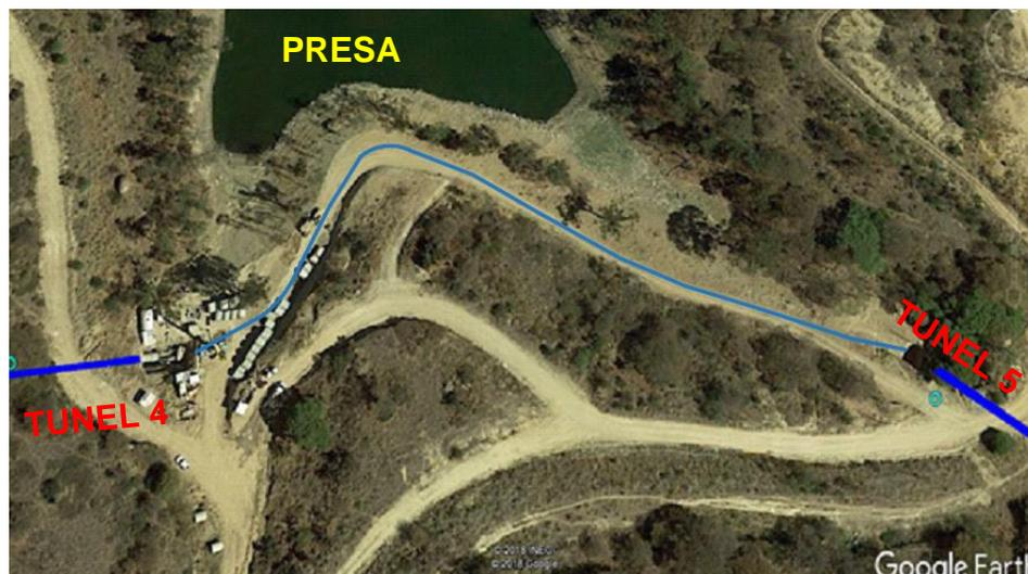
**Figura a.1.** Los túneles 4 y 5 del Colector Sur de la presa Guadalupe son unidireccionales, mientras la zona señalada con la línea entre el inicio de ambos túneles es un tramo construido a cielo abierto. Fuente: Google Earth (2017).
