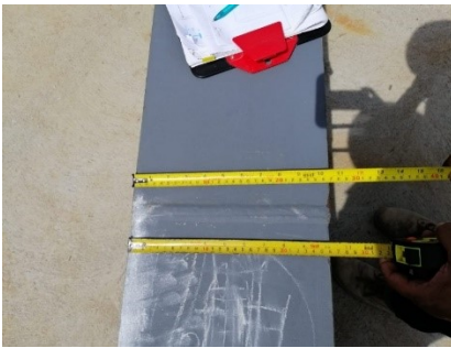
Figura 1.15 El empate de una W30X90 con patín b_f = 265 mm de acuerdo con el IMCA, del empate hacia la parte superior el elemento cumple con tolerancias, pero del empate de abajo, el elemento se encuentra al límite de la tolerancia permitida. FUENTE: Fotos detalles indicados por Supervisión, Obra Ciudad de México.
