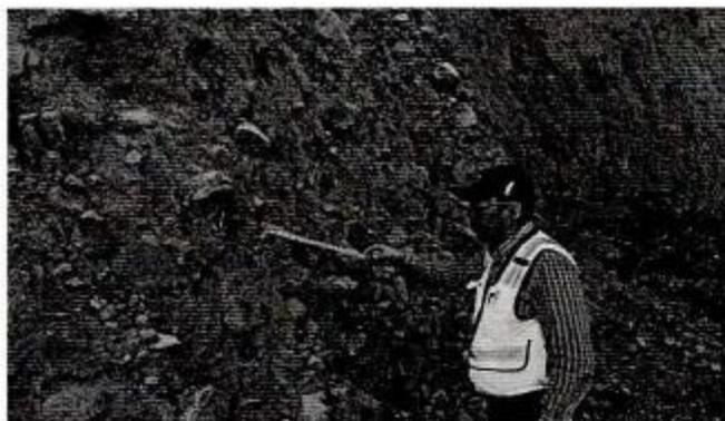
**Fotografía 13.** Detalle del depósito de lahar constituido por bloques andesíticos de tamaños variables con gravas, arenas medias a gruesas y limos en la cara del talud
