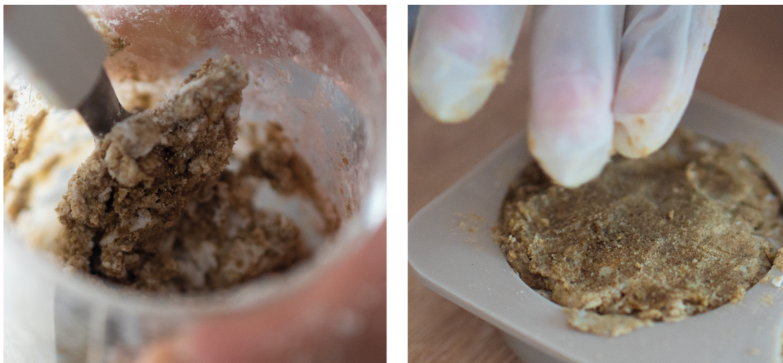
Figura 3.5. Elaboración de shampoo sólido. Izquierda: Pasta obtenida durante el mezclado. Derecha: Moldeo de la preparación en la cavidad del molde.
