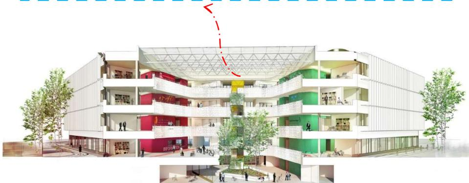
Imagen 64. Corte longitudinal del proyecto, donde se aprecia la disposición de las circulaciones. ArchDaily, Cubo + Force4, 2014, Accedido enero 2023.
