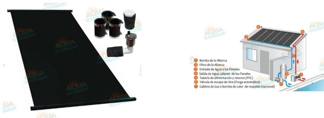
Calentador de panel solar para alberca, se emplearán un total de 18 paneles solares, para poder calentar el 50% de la capacidad de la alberca semiolímpica. Por panel tenemos una capacidad de 6,609 l, por lo que, con los 18 paneles tenemos una capacidad de 109, 250 l. Se tendrá una recirculación dentro del sistema de la alberca, en otras palabras, una instalación independiente.
