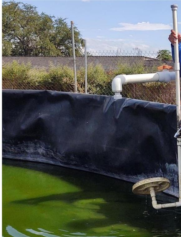
**Fig. 4.** Sistema de aireación con discos microperforados presentes en los estanques de la granja.
