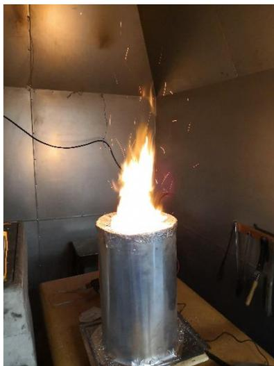
**Figura 7.** Microgasificador tipo TLUD modelo Atzimba A10XL
