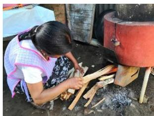
2) Se alimenta la cámara de combustión con leña y se enciende la estufa con un fosforo.
