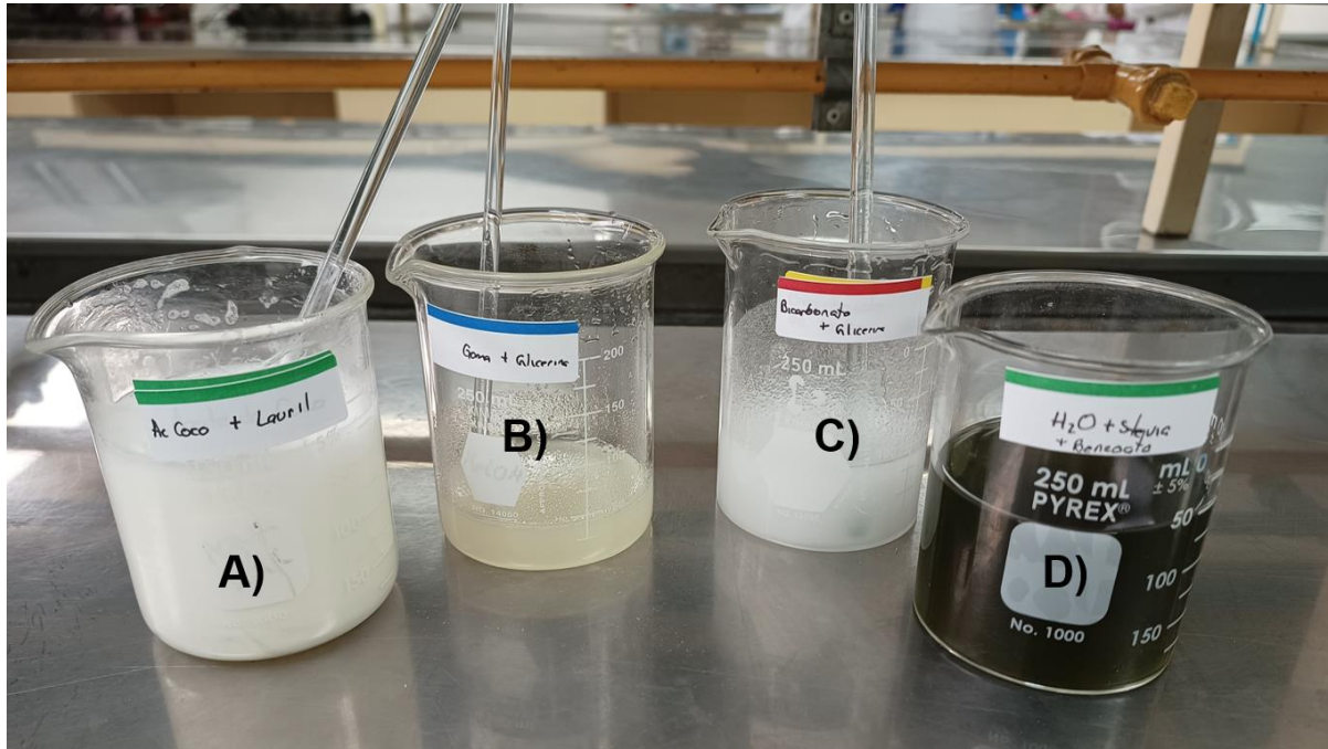
Figura 13. Disoluciones de la formulación 6. A) aceite de coco en combinación de la disolución del lauril sulfato B) goma xantana disuelta en glicerina C) Bicarbonato de sodio disuelto en glicerina D) Stevia y benzoato de sodio disueltos en agua.
