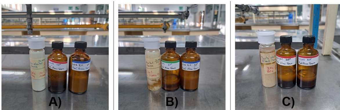
Figura 41. Frascos de formulaciones 5, 6 y 7 correspondientes a las 3 cámaras de estabilidad A) 25°C, B) 37°C, C) 50°C.
