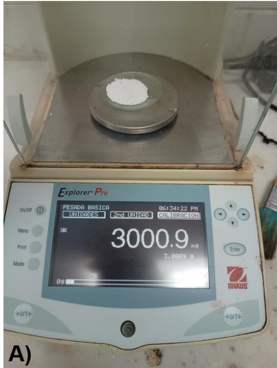
Figura 16. Dosificación de los excipientes de la formulación 7. A) uso de báscula analítica B) dosificación individual de los excipientes para la formulación 7.
