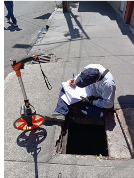
Imagen23. Recabando información de la ocupación de ductos . Autoría propia CDMX; octubre 2023.
