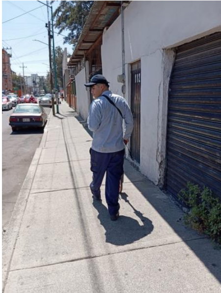
Imagen22. Medición con odómetro de centro a centro de pozo. Autoría propia CDMX; octubre 2023.
