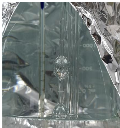
Figura 7a. Viscosímetro Ubbelohde donde A y B corresponden a los aforos del intervalo para el que se realiza la medición del tiempo recorrido. Derecha: Montaje en el laboratorio del baño a 25 °C para determinar los tiempos de caída.
