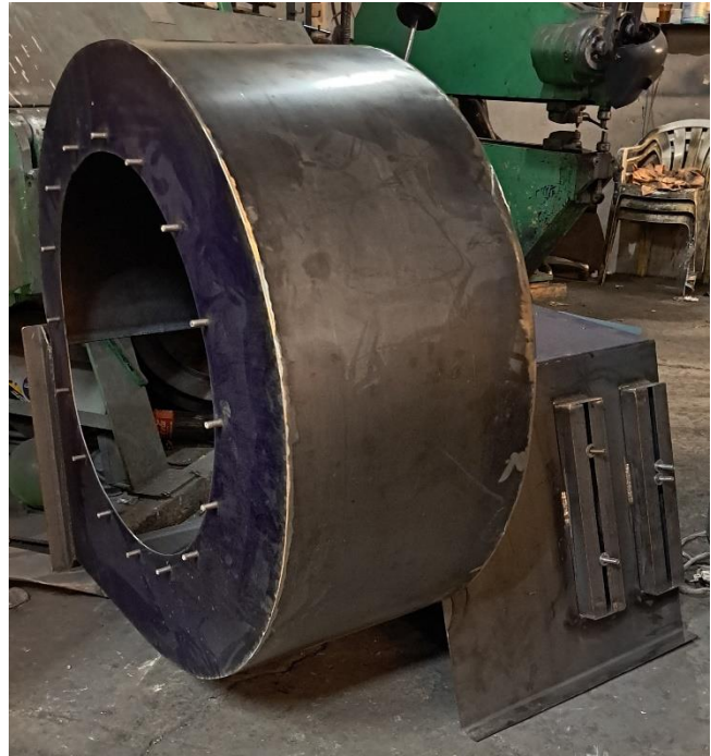
Fig. 9: Proceso de fabricación de la carcasa del ventilador PLR
