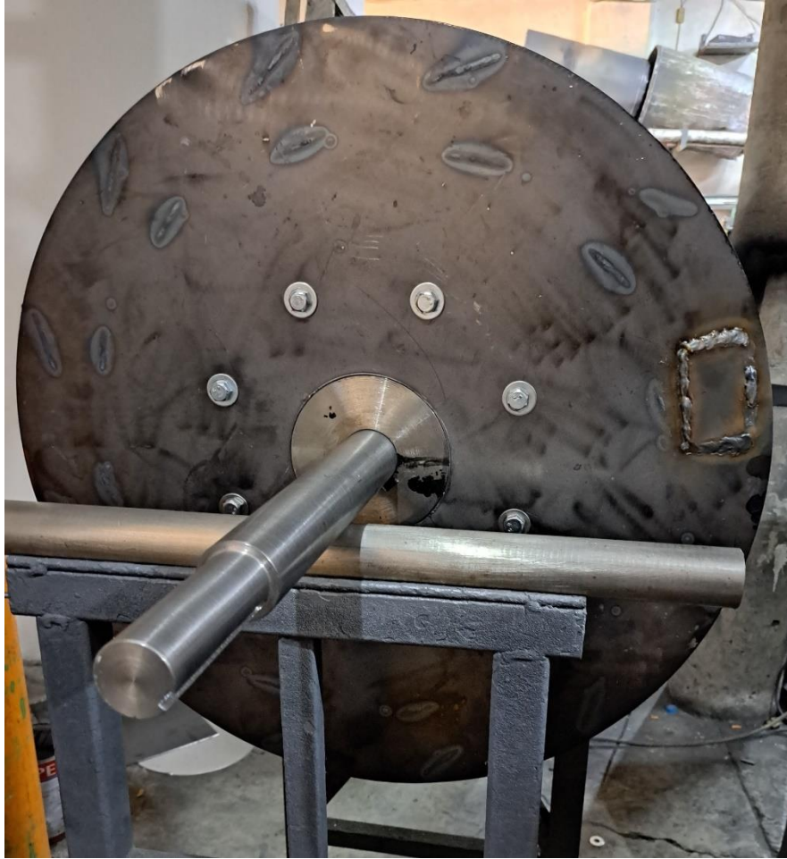
Fig. 12: Balanceo estático del ventilador PLR
