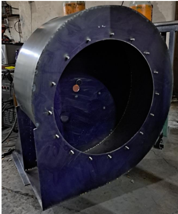
Fig. 9: Proceso de fabricación de la carcasa del ventilador PLR
