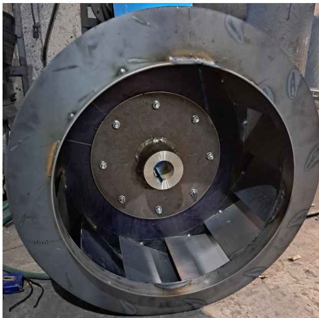
Fig. 10: Proceso de fabricación del ventilador PLR
