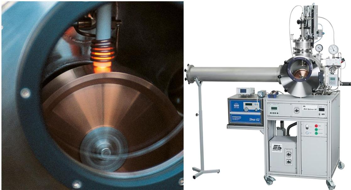
**Figura 4.2. Sistema de temple rotatorio de la marca Edmund Bühler GmbH modelo “melt spinner SC”.**
