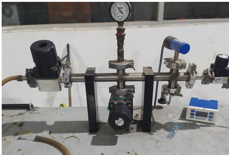
**Figura 4.4. Sistema de vacío empleado en el encapsulado de las muestras.**
