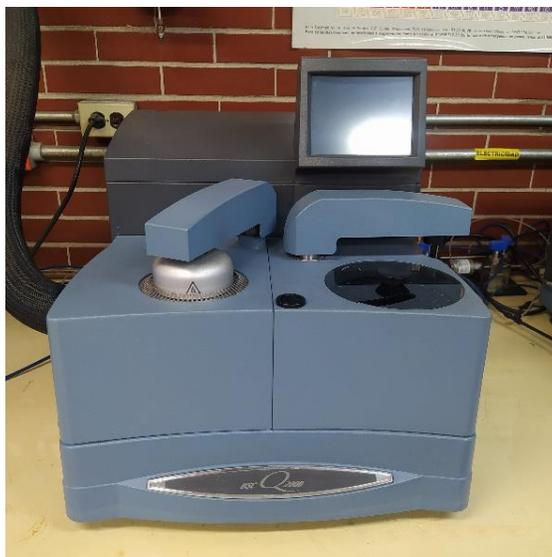
**Figura 4.8. Fotografía de un DSC de la marca TA Instruments modelo DSC2000.**
