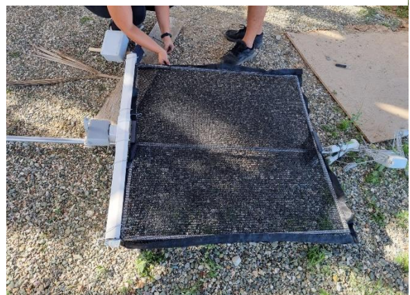
Imagen 7. Radar de niebla antes de ser instalado
