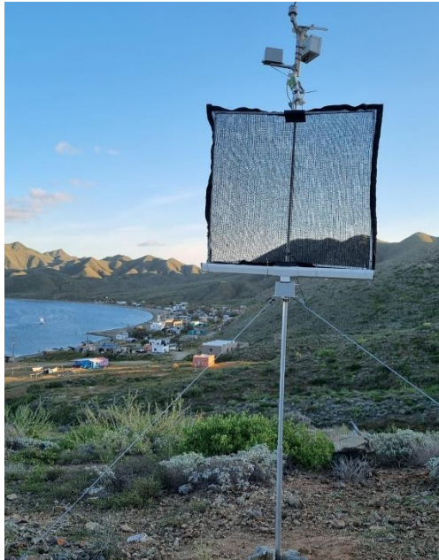
Imagen 6. Radar de niebla en Baja California Sur
