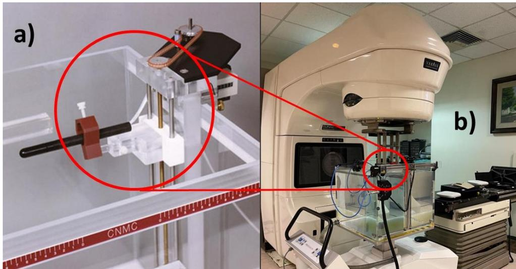
Figura 15. a) Cámara de ionización montada sobre los rieles del tanque de dosimetría; b) Acelerador lineal Varian Clinac 2100 CD; tanque de dosimetría en geometría SSD para caracterización del haz de electrones
