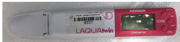
Figura 22.- Medidor Horiba para conductividad eléctrica.
