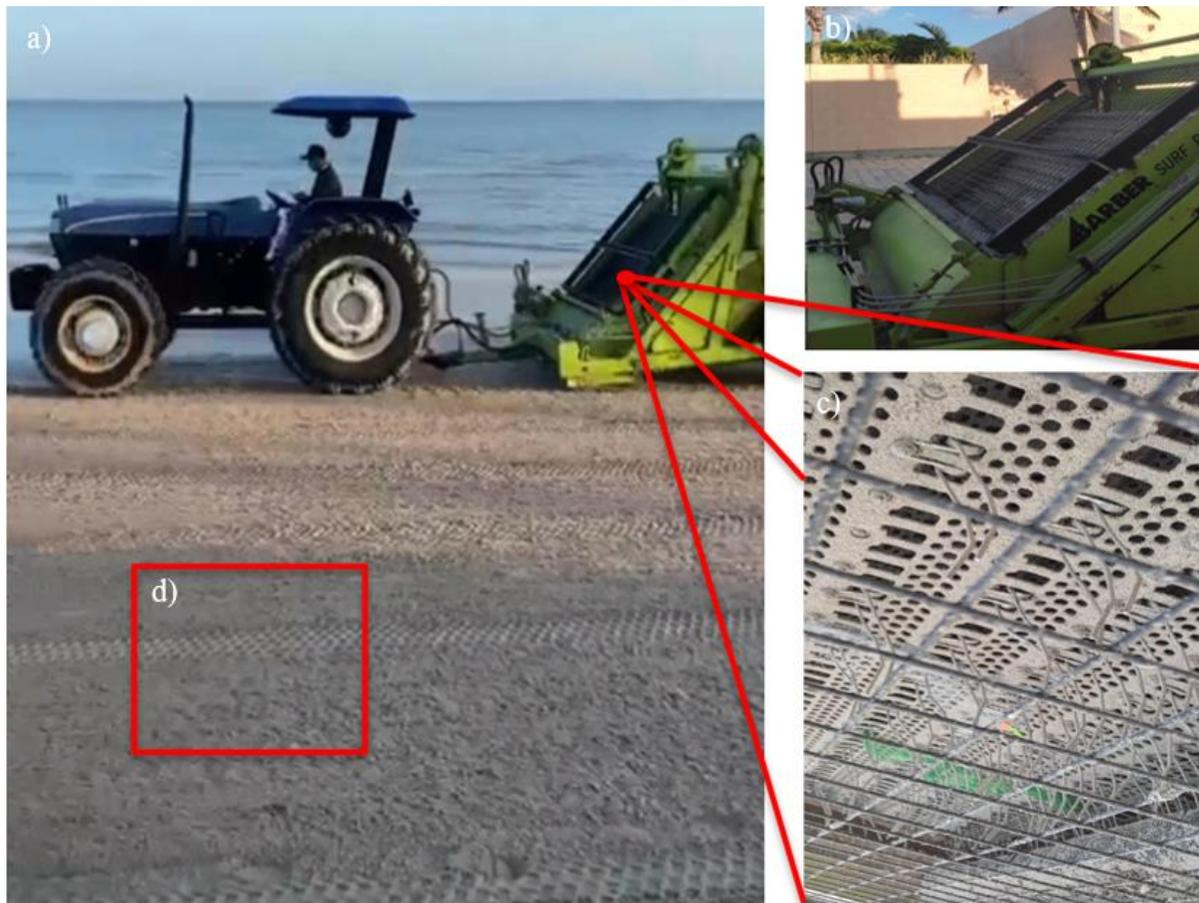
Figura 24. a) *Actividad matutina del tractor recolector de basura en las playas de Progreso publicada por el edil*; b) *cargador trasero*; c) *anillo dinámico barredor*; d) *suelo compactado por el vehículo motorizado*.
