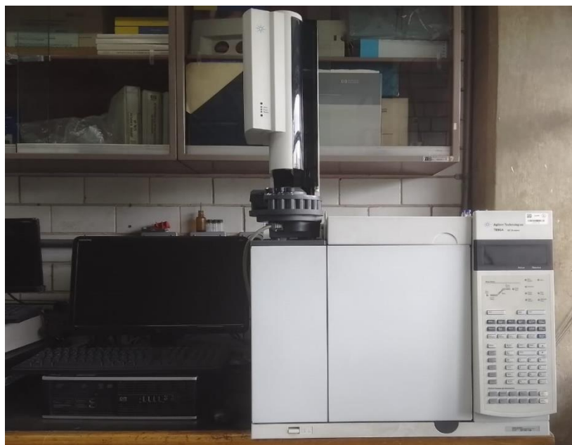
Figura 17. Cromatógrafo de gases (foto tomada en el UNICAT).
