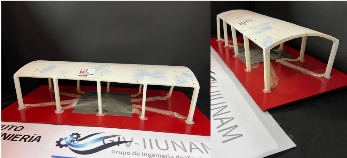
Figura 5.11 Modelo 1 ( \beta = 14^\circ ) finalizado de la etapa de construcción
