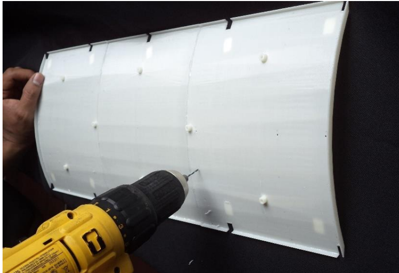
Figura 5.5 Perforación de las cubiertas con broca de 1.59 mm
