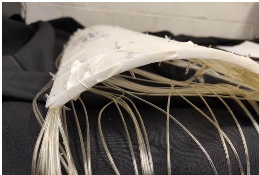
Figura 5.8 Ensamble de las cubiertas con arreglo de mangueras por columna
