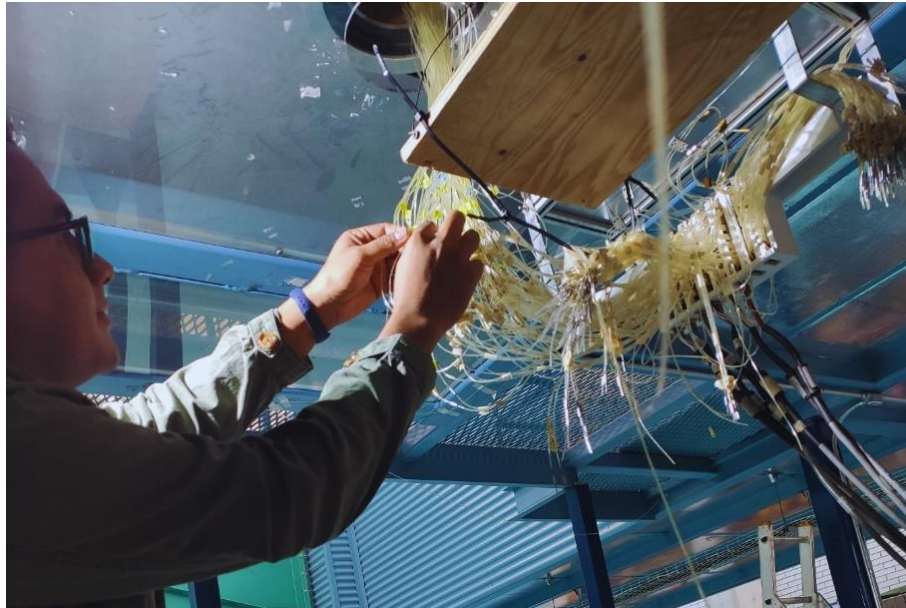
Figura 5.13 Instrumentación con sensores de presión
