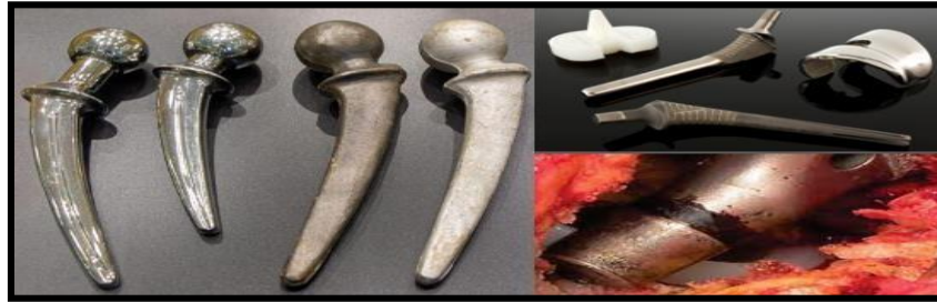
Fig. 1.4. Muestra gráfica de la corrosión en implantes. Tomada de: Tribología moderna en artroplastía total de cadera: pros y contras.
