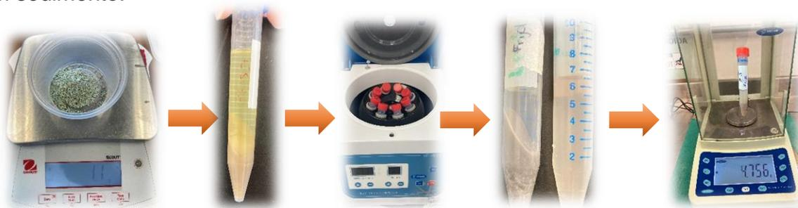
**Fig. 5. Diagrama de flujo para determinación de solubilidad.**
