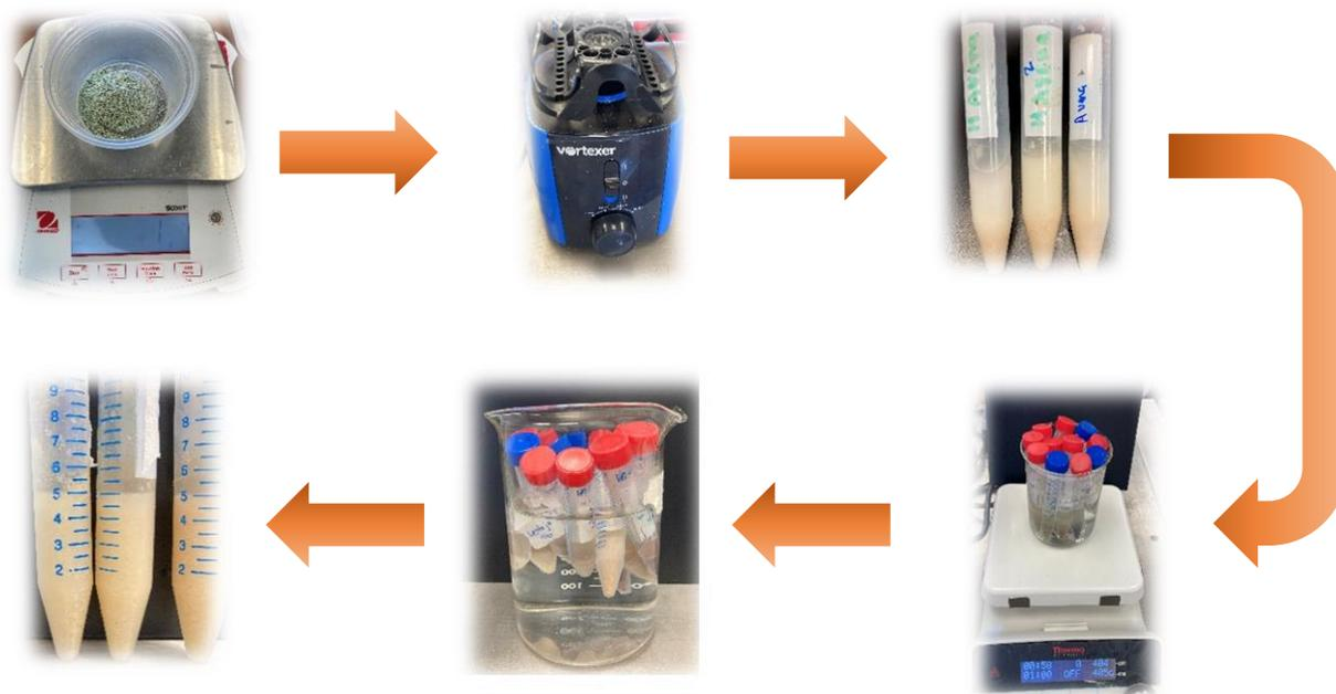
Fig. 6. Diagrama de flujo para determinación de gelificación.
