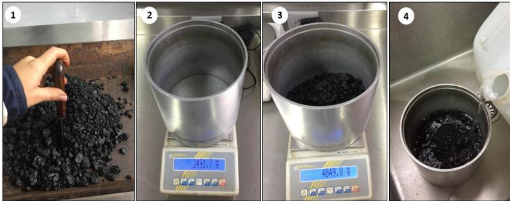
Figura 35. Determinación de la densidad máxima teórica en mezclas asfálticas – Mezcla asfáltica densa.
