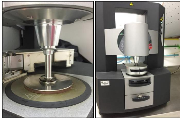
Figura 29. Reómetro de corte dinámico (DSR)
