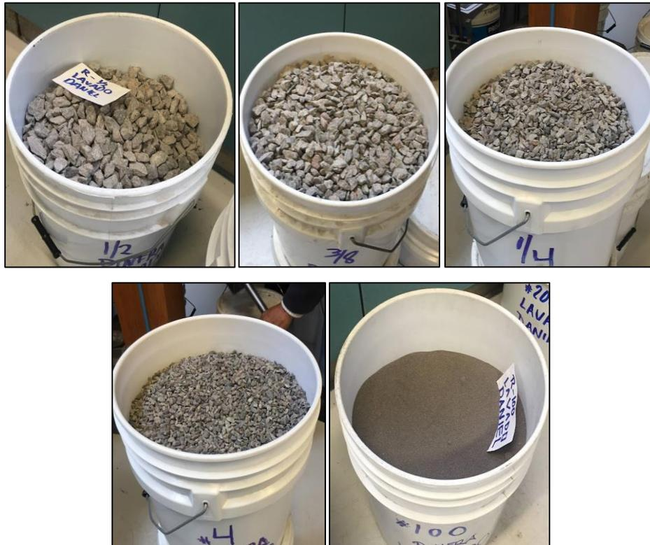
Figura 28. Agregado pétreo mezcla asfáltica OGFC
