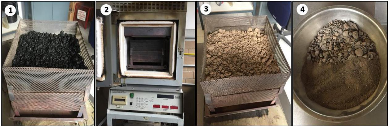
Figura 26. Determinación del contenido de cemento asfáltico de la mezcla por el método de ignición.
