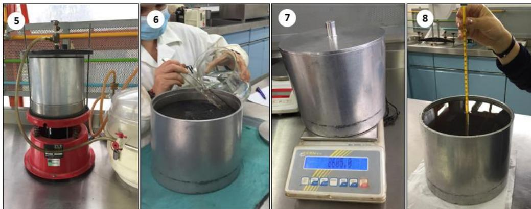
Figura 36. Determinación de la densidad máxima teórica en mezclas asfálticas 2da parte – Mezcla asfáltica densa.
