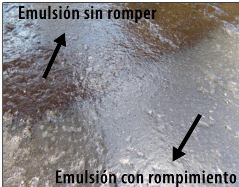
Figura 12. Rompimiento de emulsión asfáltica [16]
