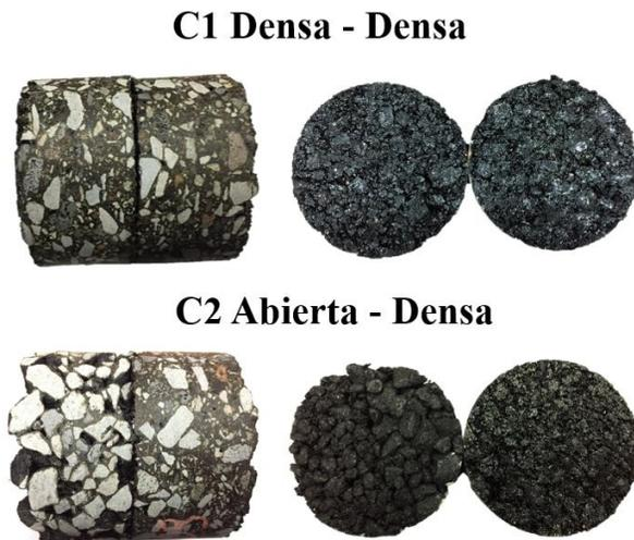
*Figura 49. Sistemas bi-capa de concreto asfáltico C1 y C2*
