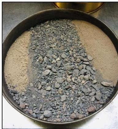
Figura 27. Agregado pétreo mezcla asfáltica densa.
