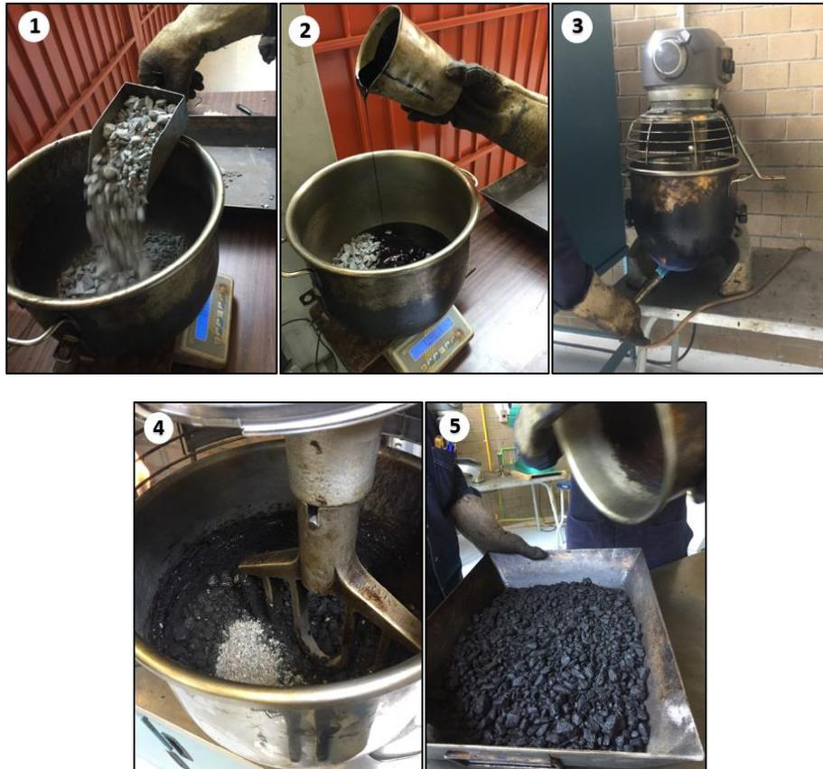
Figura 38. Proceso de mezclado – OGFC
