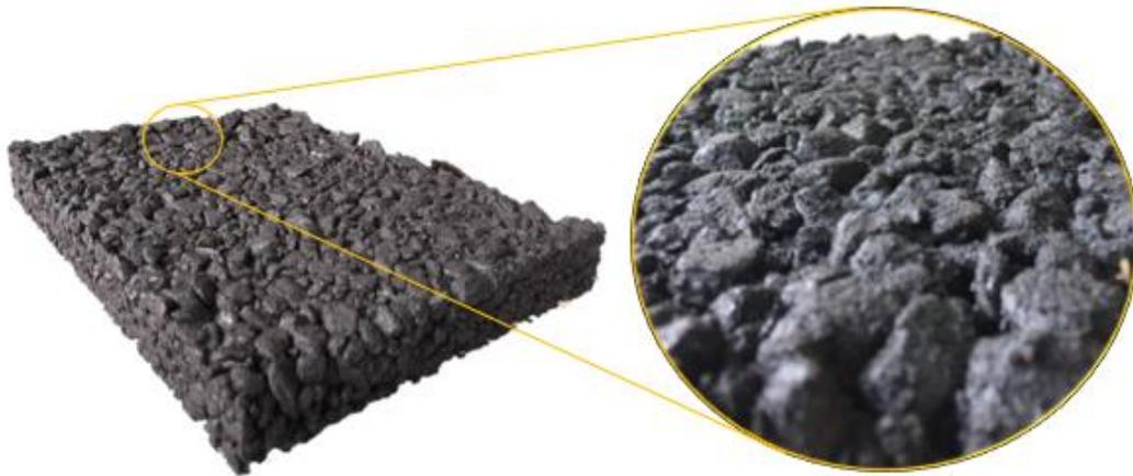
Figura 23. Mezcla asfáltica de granulometría OGFC
