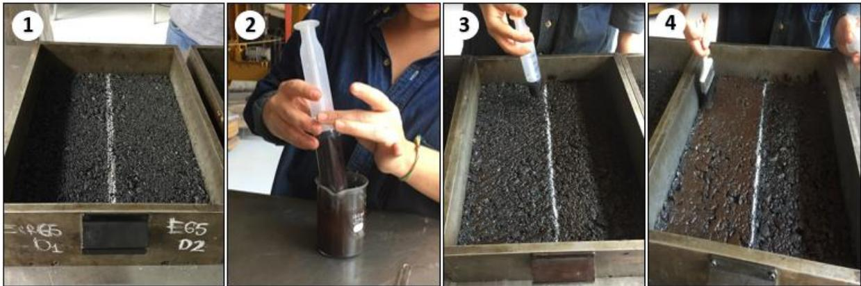
Figura 42. Aplicación de emulsión asfáltica.
