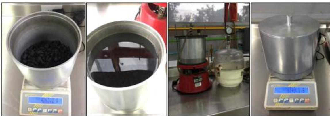
Figura 39. Determinación de la densidad máxima teórica en mezclas asfálticas – Mezcla asfáltica OGFC
