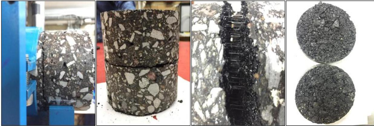
Figura 47. Espécimen fallado a corte.
