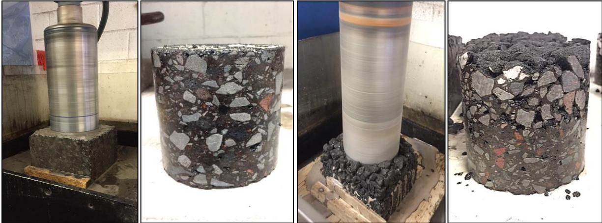
Figura 44. Extracción de núcleos C1 y C2.
