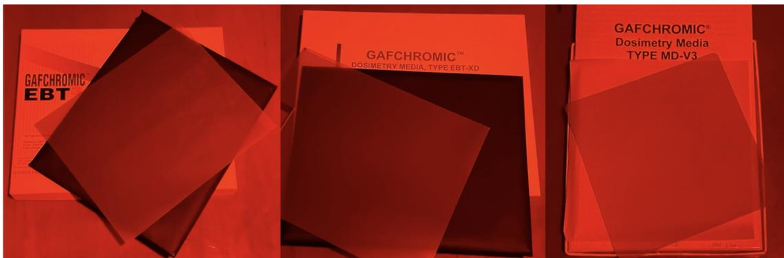
Figura 3.1: Modelos de películas radiocrómicas utilizadas en este trabajo. Fotografías tomadas bajo condiciones de luz controlada.
