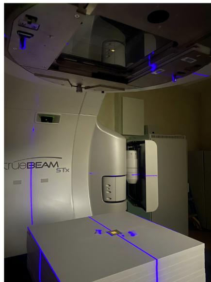
Figura 3.12: Configuración experimental utilizada durante las irradiaciones de la película EBT-3 para la determinación de los tamaños de campo cuadrado equivalente con y sin filtro de aplanado. La imagen de la derecha muestra la película colocada a 10 *cm* antes de que sea cubierta por los 10 *cm* restantes que le dan dicha profundidad.
